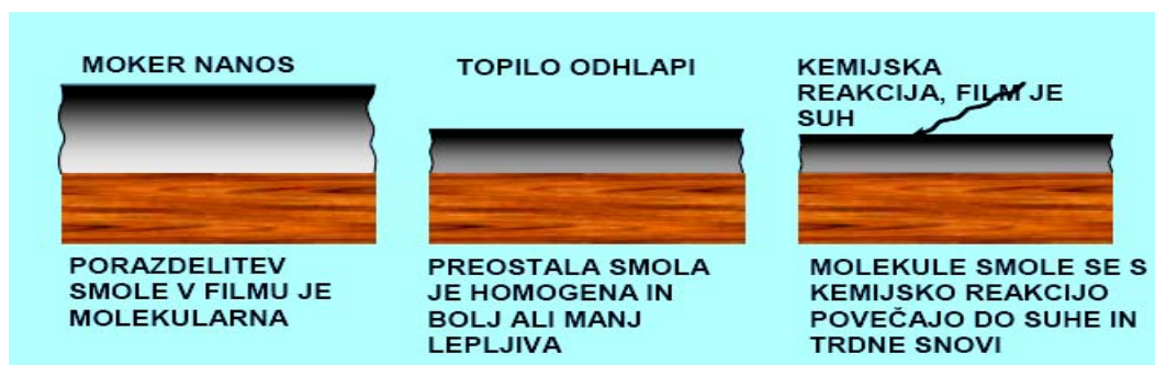
Slika 10: Shematski prikaz fizikalno kemičnega sušenja poliuretanskega laka (Podobnik, 2006)
