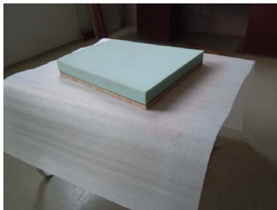
Slika 25: Sestava sedeža, spodaj iverna plošča in zgoraj prilepljena spominska pena
