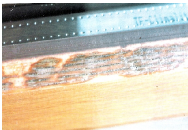
Slika 12: Posledica direktnega stika les, aluminij
