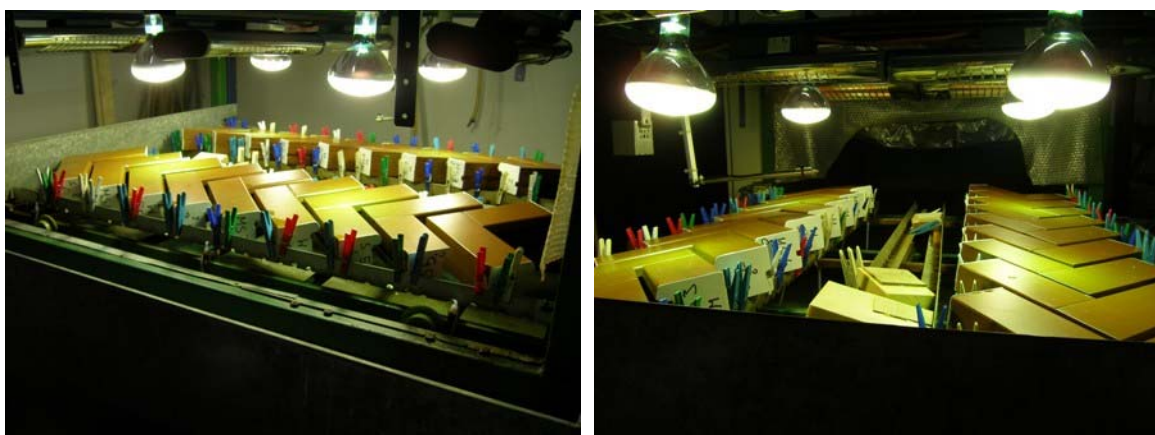
Slika 35: Delovanje komore (svetloba in infrardeči grelci)
