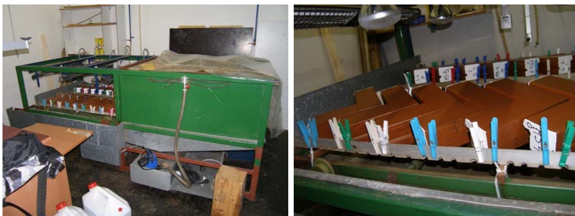
Slika 34: Komora za umetno pospešeno staranje lesa
