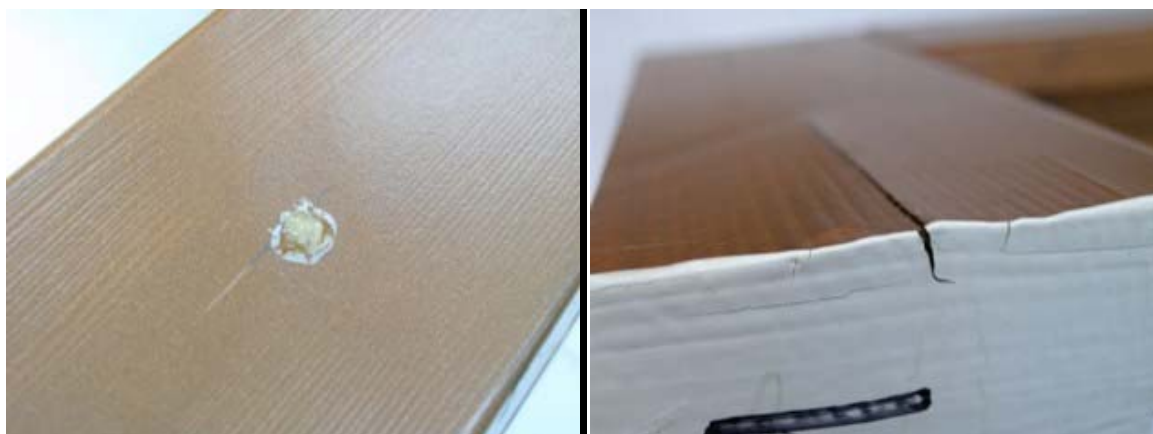
Slika 49: Smolni izcedek (levo) in razpoke (desno)
