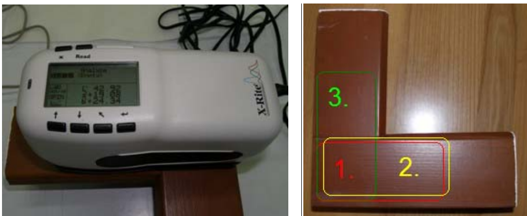
Slika 32: Merilnik za merjenje barve in mesta merjenja
