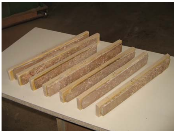
Slika 32: Vzorca stene C, pripravljeni za dendrokronološko analizo - desno.
