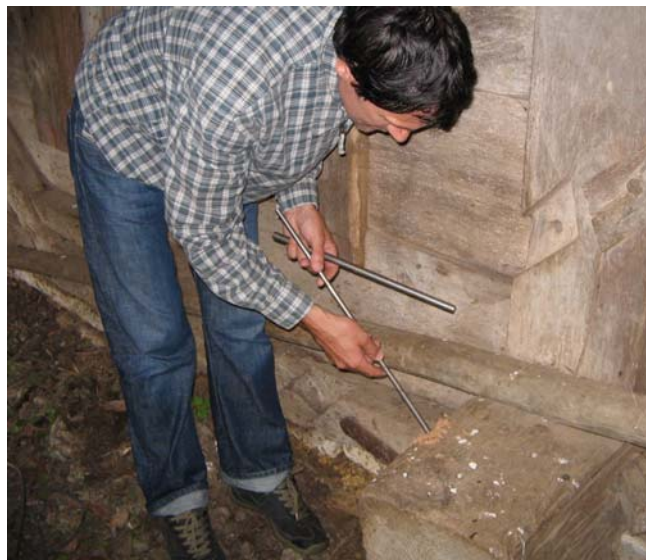
Slika 40: Izvlek izvrtanega vzorca za dendrokronološko analizo - desno.
