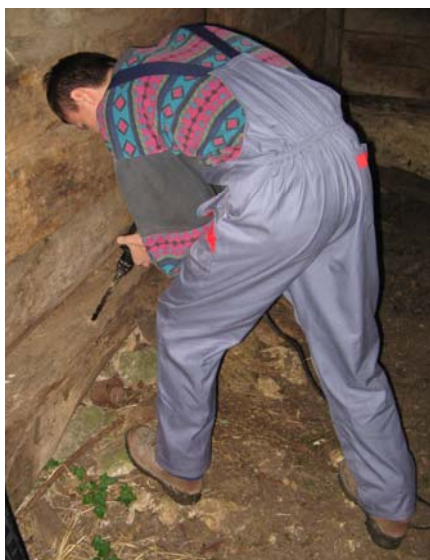
Slika 39: Vrtanje vzorca za dendrokronološko analizo - levo.
