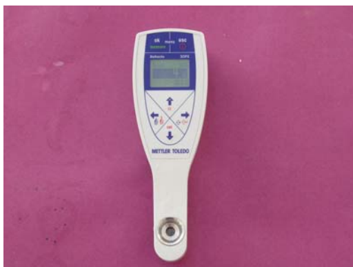
Refraktometer: naprava za merjenje skupnih sladkorjev.
