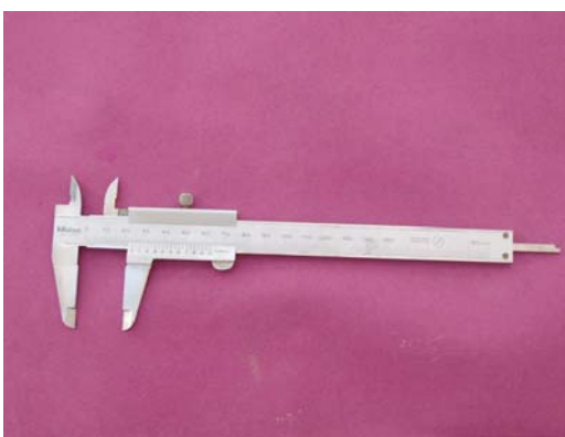
Kljunasto merilo za merjenje višine in debeline ploda ter debeline perikarpa in velikost placentne.
