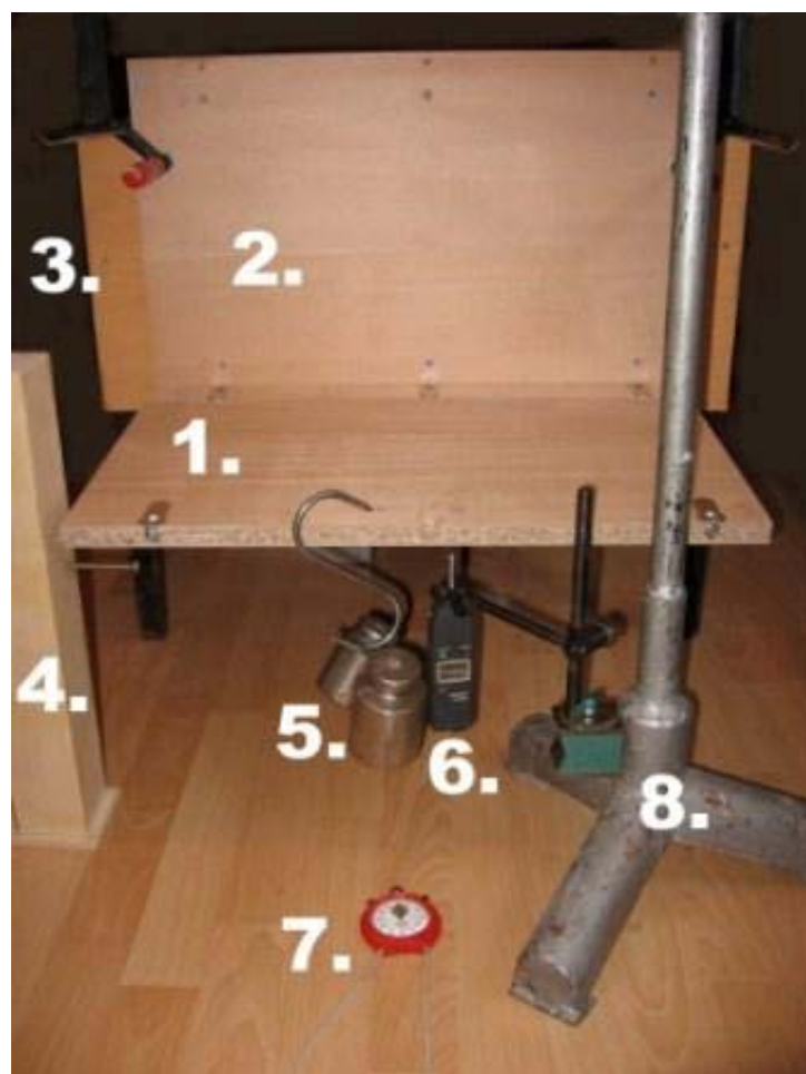
Slika 24: Način preizkušanja obodne kotne vezi
