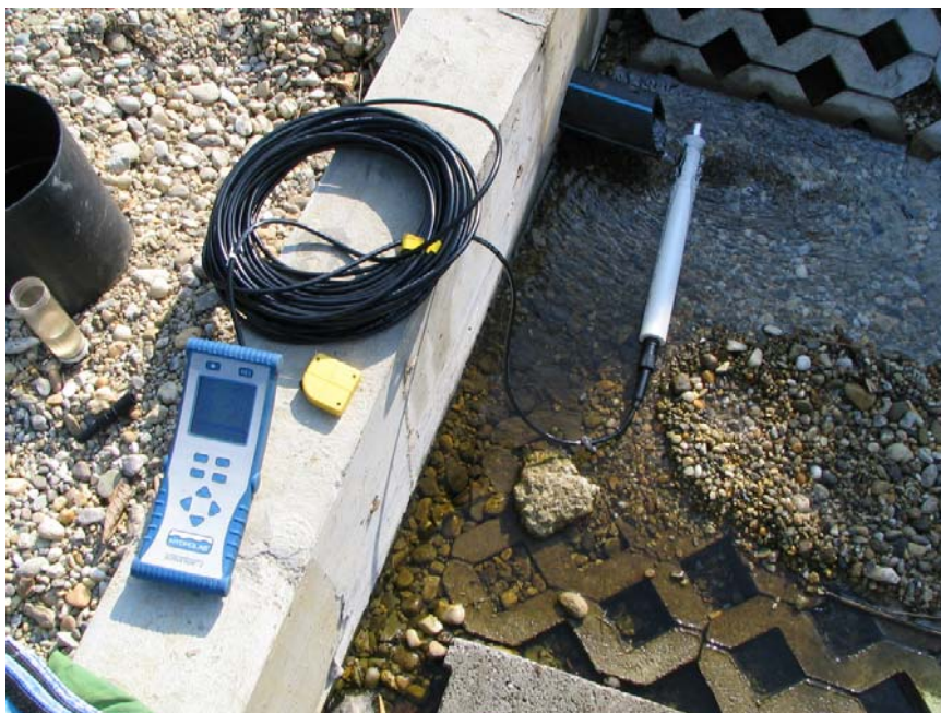
Slika 10: Merjenje zadrževalnega časa vode v ERM jarku pri Lešnici z metodo elektroprevodnosti
