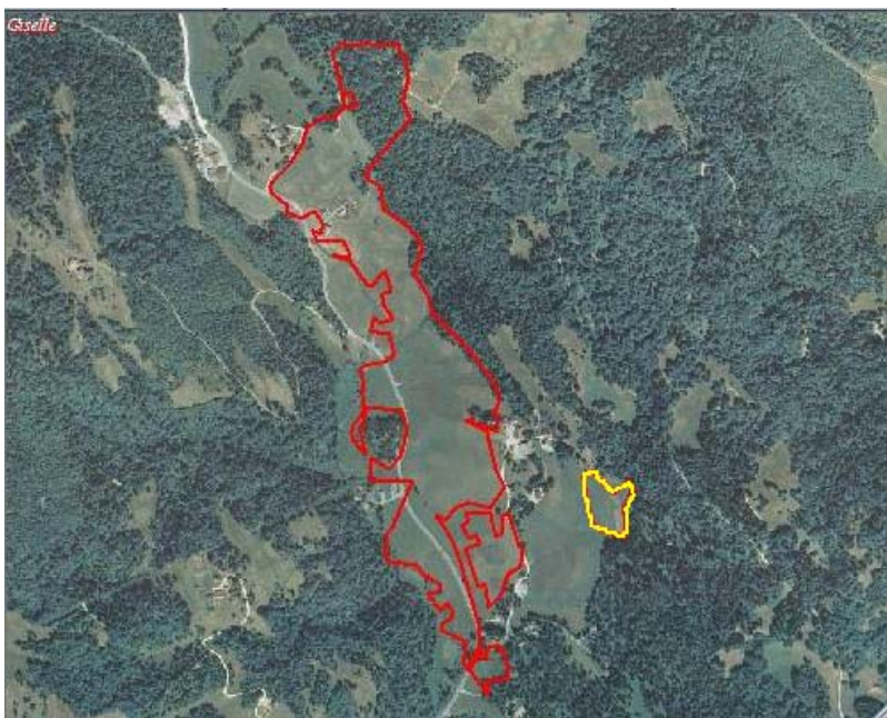
Slika 3: MO Reška dolina v sistemu KatMeSiNa (merilo 1 : 15000 - pomanjšano) (rdeče - načrtovano in izvedeno po projektni dokumentaciji, rumeno – nenačrtovano in neizvedeno) (kartografska podlaga: Kataster melioracijskih sistemov in naprav, 2007)
