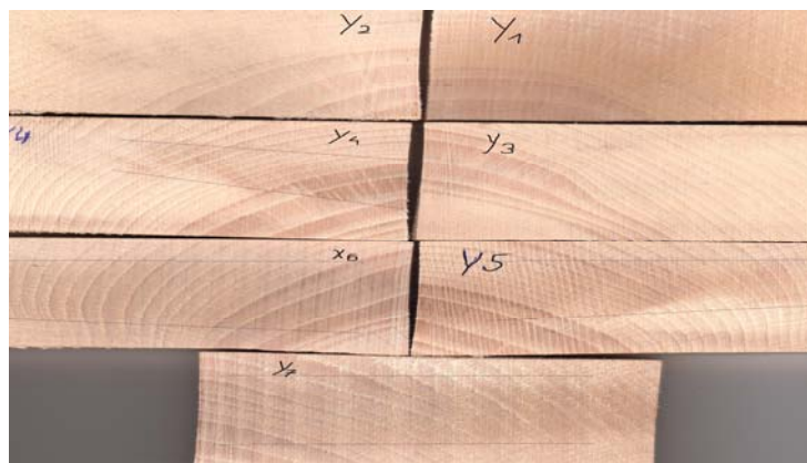
Priloga E.7 Odrezki za ocenjevanje barve iz vzorčne deske Z (šarža 5) v sedmih območjih vlažnosti.
