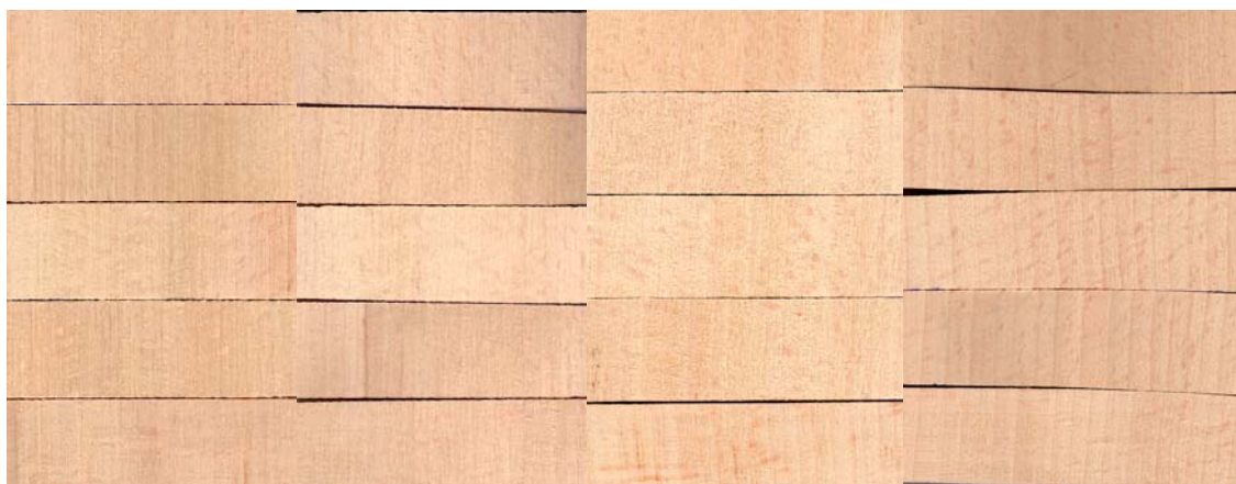
Slika 13: Odrezki (sloji) za ocenjevanje barve iz vzorčnega decimiranega elementa X (iz šarže 7). Stolpec 1 levo ( u_{24\%} ), stolpec 2 ( u_{19\%} ), stolpec 3 ( u_{13\%} ) in stolpec 4 skrajno desno ( u_{KON.} ).
