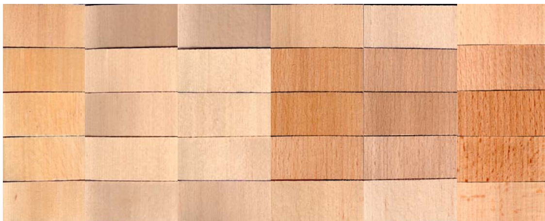
Slika 12: Odrezki (sloji) za ocenjevanje barve iz vzorčne deske Y (šarža 7). Stolpec 1 levo ( u_{ZAČ.} ), stolpec 6 skrajno desno ( u_{KON.} ).
