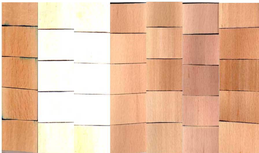
Priloga E.10 Odrezki (sloji) za ocenjevanje barve iz vzorčne deske 1(šarža 6). Stolpec 1 levo ( u_{ZAC.} ), stolpec 7 skrajno desno ( u_{KON.} ).
