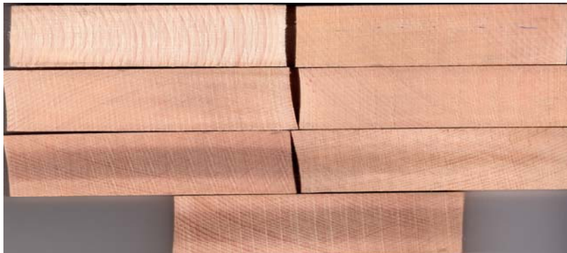
Slika 11: Odrezki za ocenjevanje barve iz vzorčne deske 1 (šarža 6). Stolpec 1 levo ( u_{35\%} , u_{25\%} , u_{15\%} ), stolpec 2 desno ( u_{ZAČ.} , u_{30\%} , u_{20\%} ) in vzorec spodaj ( u_{KON.} ).
