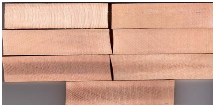
Priloga E.9 Odrezki za ocenjevanje barve iz vzorčne deske 2 (šarža 6) v sedmih območjih vlažnosti.
