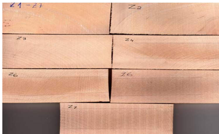
Priloga E.7 Odrezki za ocenjevanje barve iz vzorčne deske Z (šarža 5) v sedmih območjih vlažnosti.
