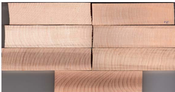
Priloga E.9 Odrezki za ocenjevanje barve iz vzorčne deske 2 (šarža 6) v sedmih območjih vlažnosti.
