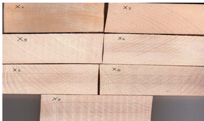
Priloga E.5 Odrezki za ocenjevanje barve iz vzorčne deske X (šarža 5) v sedmih območjih vlažnosti.
