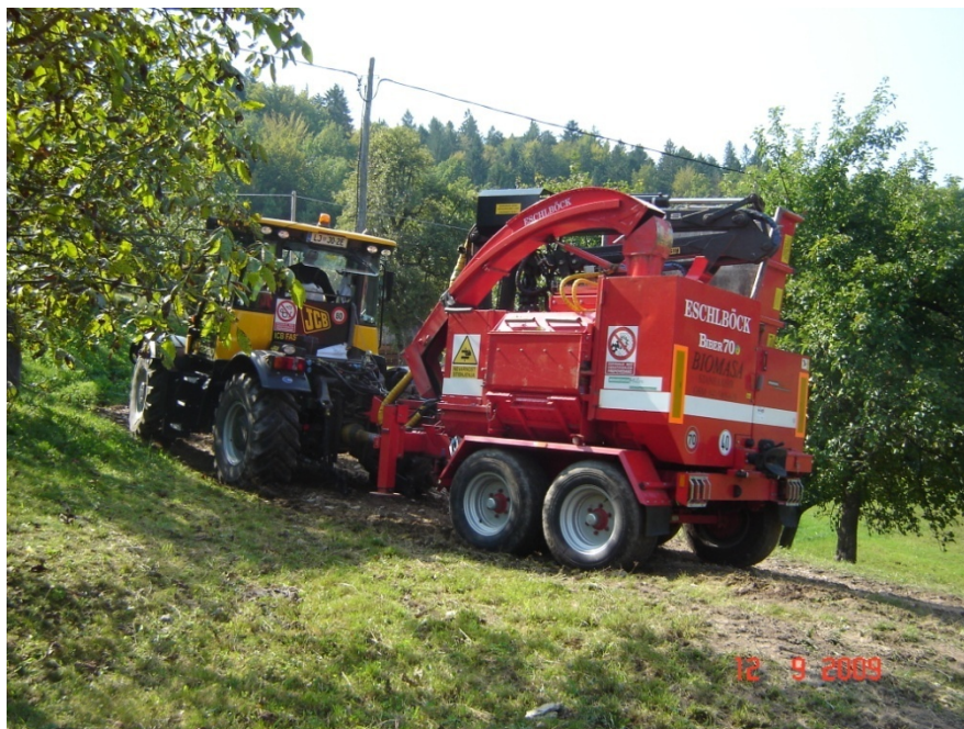
Slika 1: Sekalnik Eschlböck Biber 70 za izdelavo lesnih sekancev (foto: P. Kucler)
