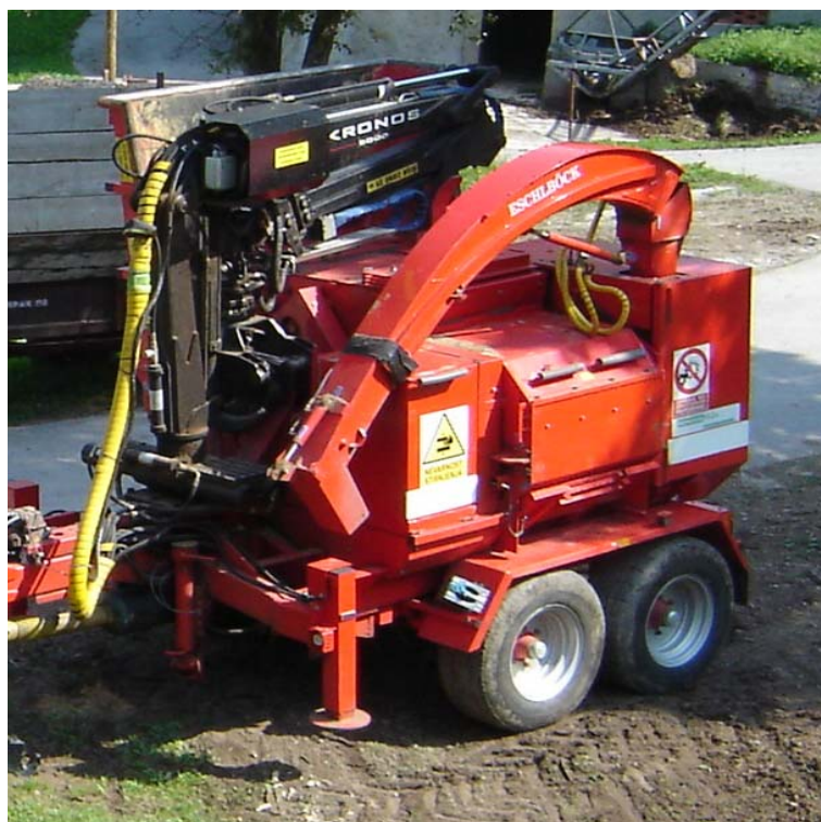
Slika 11: Sekalnik Eschlböck Biber 70 z nakladalno napravo Kronos 5000 (foto: P. Kucler)
