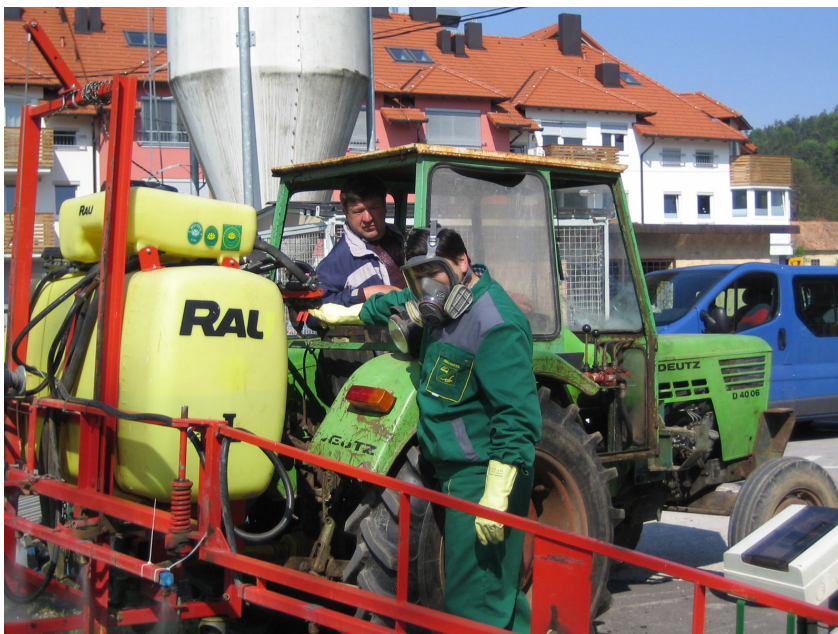
Slika 6: Traktorska nošena škropilnica (foto: Š. Kuhar)
