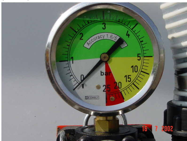
Slika 15: Manometer z logaritmsko skalo, z razdelkom po 0,1 bar do 5 bar (foto: Š. Kuhar)
