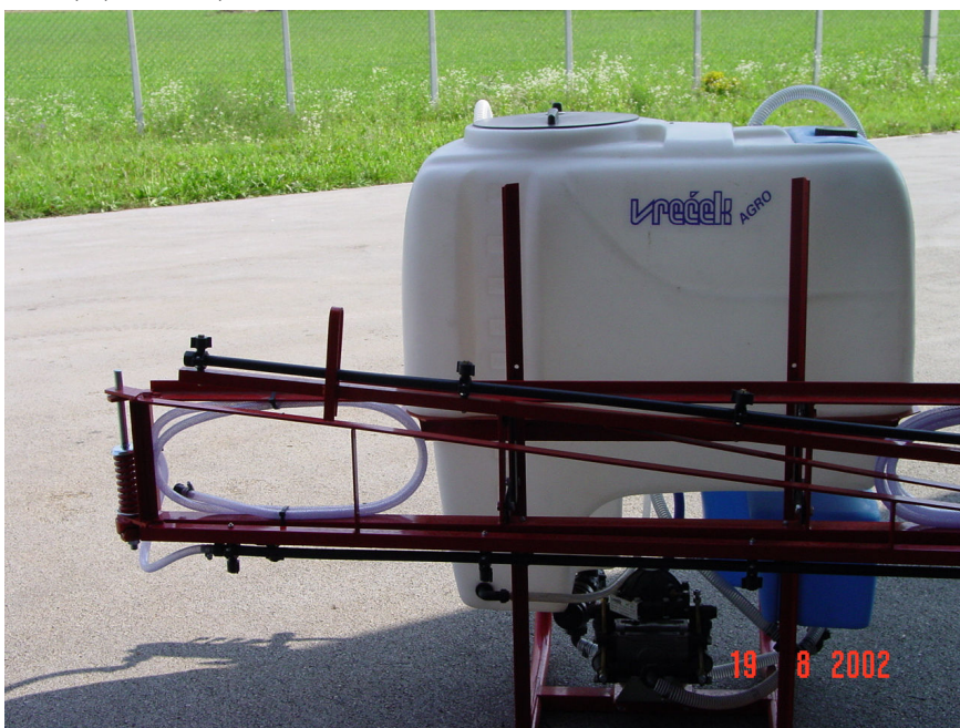
Slika 16: Škropilne letve se morajo vključiti in izključiti v najmanj dveh delih (levo, desno) (foto: Š. Kuhar)
