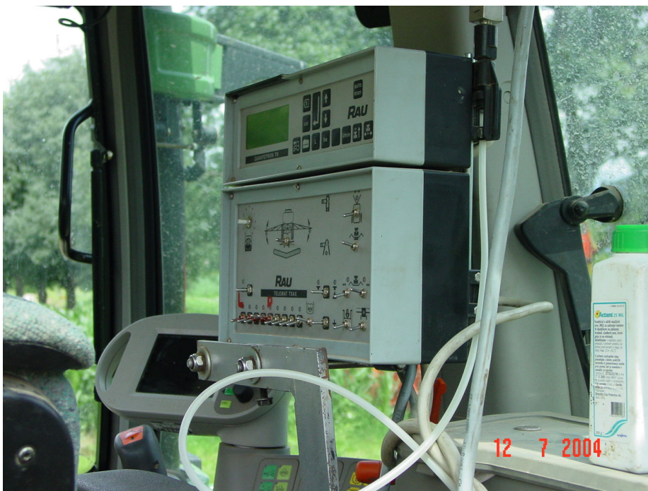
Slika 13: Krmilni mehanizmi morajo biti dosegljivi z delovnega mesta in ne smejo ovirati gibanja traktorista na delovnem mestu (foto: Š. Kuhar)
