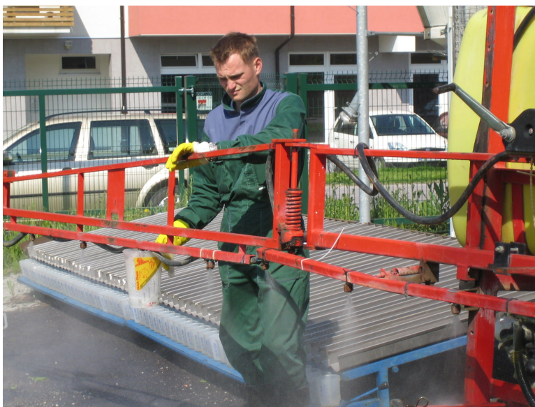
Slika 22: Merjenje pretoka posamezne šobe (foto: Š. Kuhar)
