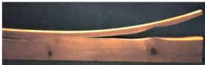
Slika 35: Krčenje kompresijskega lesa v vzdolžni smeri med sušenjem (Gorišek, 2006a)
