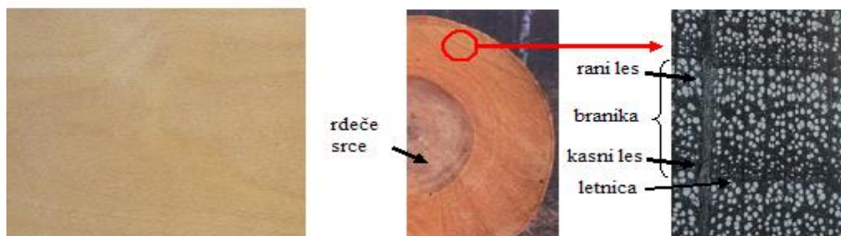
Slika 20: Bukovina – tangencialna površina, prečni prerez (makroskopsko, mikroskopsko) (Wagenfür, 1996)
