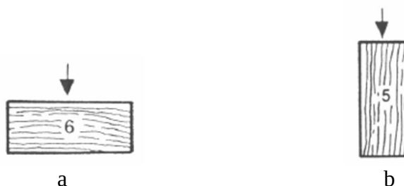
Slika 41: Smer delovanja sile pri tlačnem obremenjevanju glede na potek aksialnih elementov: (a) vzporedno in (b) pravokotno
