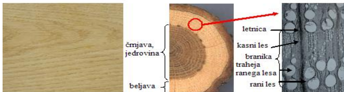
Slika 27: Hrastovina – tangencialna površina, hrastovina prečni prerez (makroskopsko, mikroskopsko) (Wagenfür, 1996)
