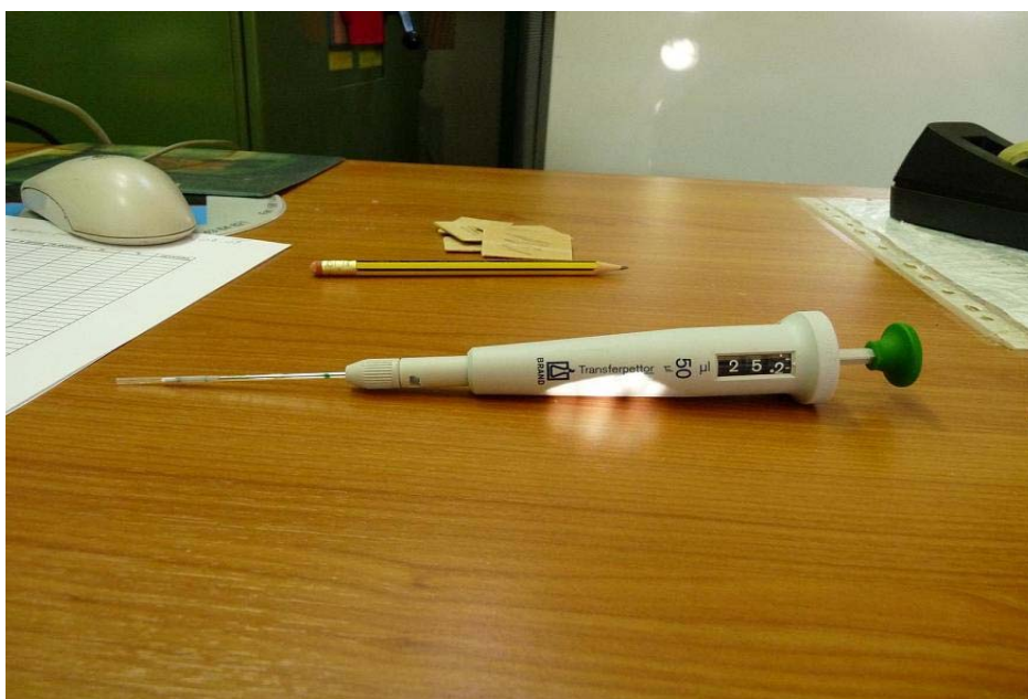
Slika 5: Pipeta za nanos lepila
