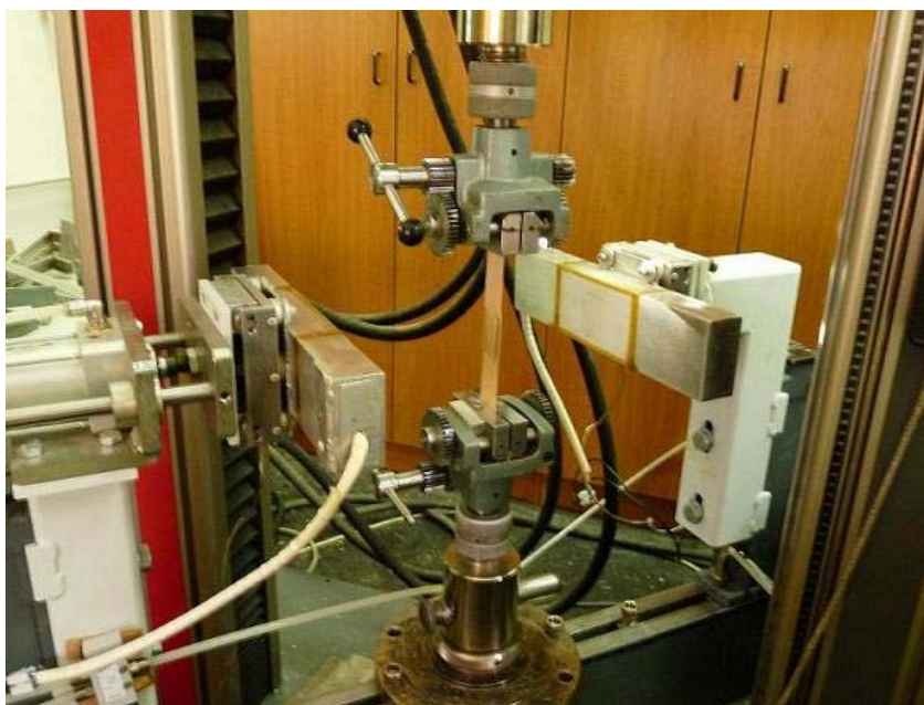
Slika 6: Preskušanec vpet v vpenjalni čeljusti testirnega stroja Zwick Z100
