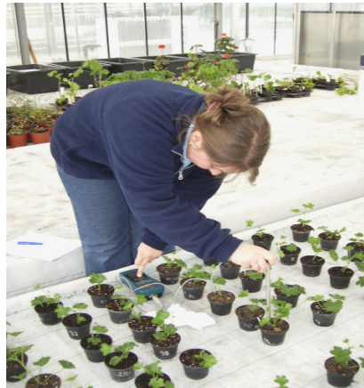
Slika 5: Konduktometer Stelzener PET 2000 KOMBI in meritev v rastlinjaku Biotehniške fakultete, 2006.
