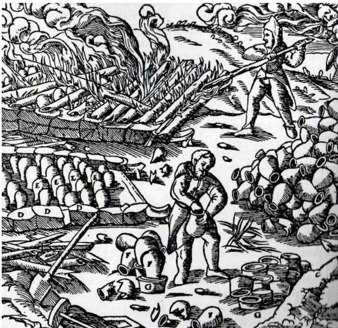
Slika 2: Žganje rude v vrčih, Georgius Agricola, De re metallica, 1556 (vir: Čar, 1993)
