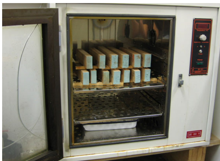
Slika 3.4: Komora za sušenje lesa z delno izmenjavo zraka (Laboratorij za sušenje lesa, Oddelek za lesarstvo)
