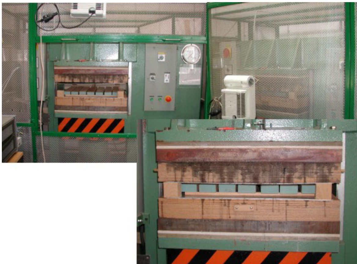
Slika 3.7: Visokofrekvenčna sušilnica (Laboratorij za žagarstvo in lesna tvoriva, Oddelek za lesarstvo)
