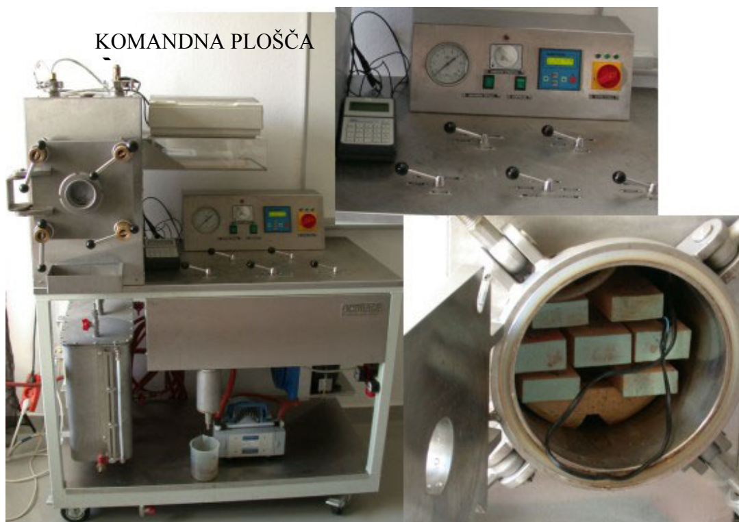
Slika 3.5: Vakuumaska komora (Laboratorij za zaščito lesa, Oddelek za lesarstvo)
