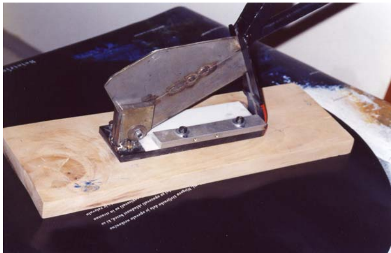
Slika 12. Naprava za pripravljanje slojev za določanje gradienta vlažnosti (Lapanja 2004)
