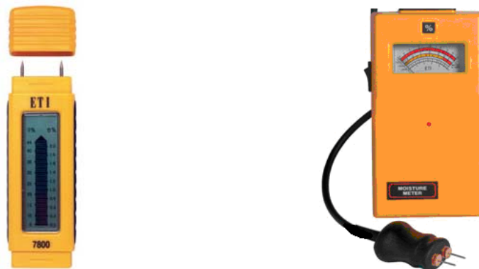
Slika 5: Uporovna merilnika vlažnosti
