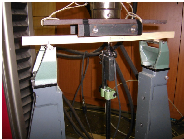
Slika 13: Naprava za testiranje štiri točkovni upogib, Zwick Z100
