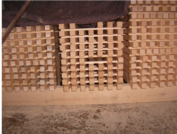
Slika 11: Dolžinsko zlepljeni preizkušanci za ugotavljanje mehanskih lastnosti
