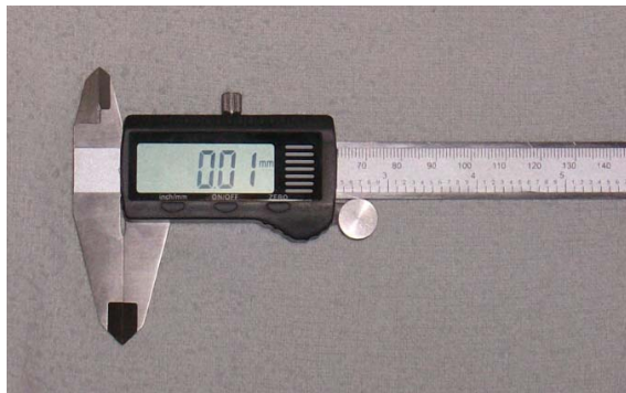
Slika 18: Kljunasto merilo za merjenje dimenzij preizkušanca
