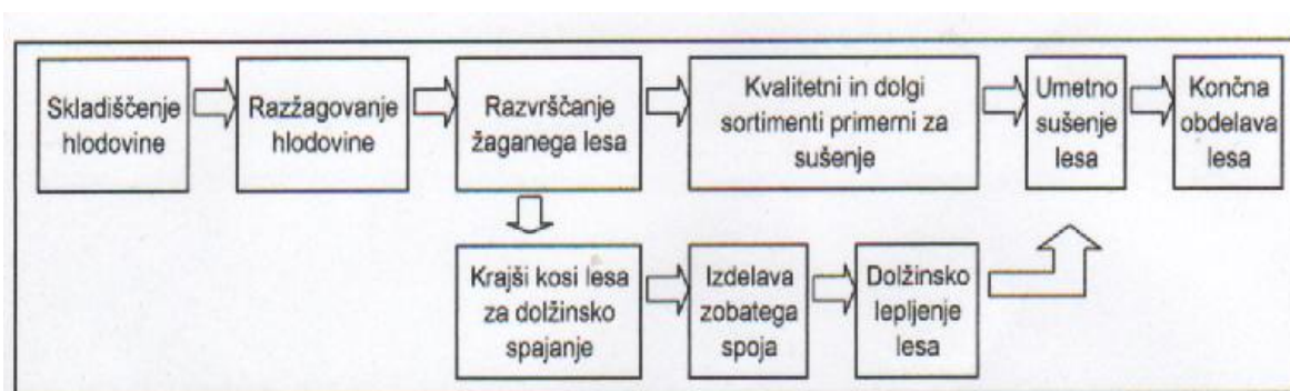
Slika 7: Diagram poteka dolžinskega lepljenja svežega lesa s pomočjo zobatega spoja za konstrukcijsko uporabo (Šernek in Kuronja, 2007)
