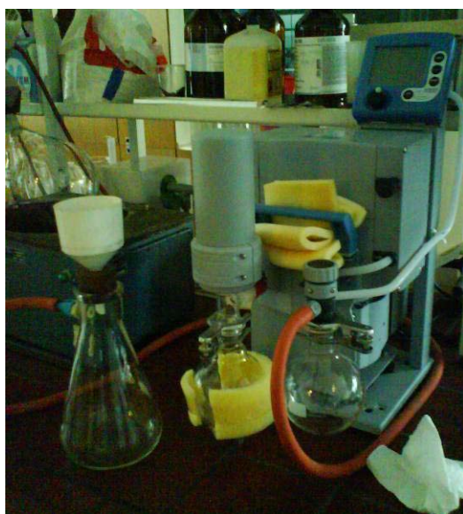
Slika 10: Visokozmogljiva membranska črpalka (levo) in Rotavapor (desno).
