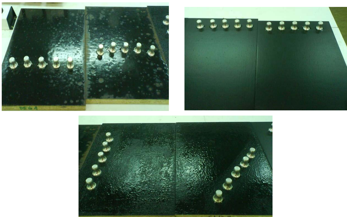
Slika 19: Določanje oprijemnosti z metodo odtrgovanja pečatov (površinski sistemi: DEG - zgoraj levo, EX DEG - zgoraj desno ter GLIC - spodaj).
