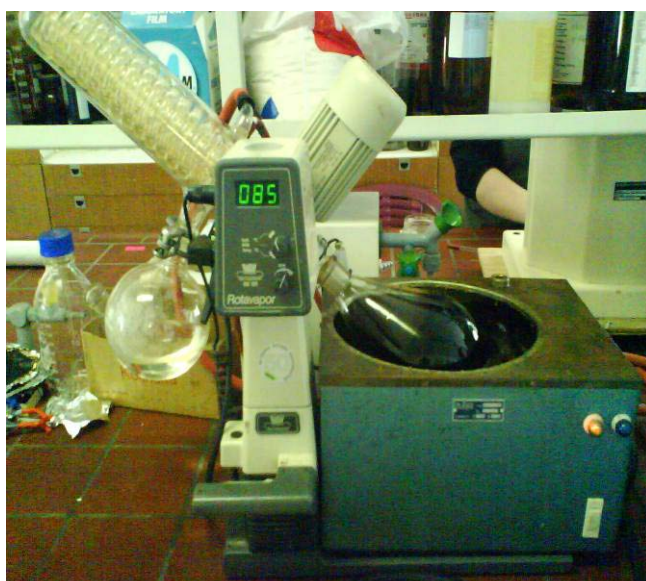
Slika 10: Visokozmogljiva membranska črpalka (levo) in Rotavapor (desno).
