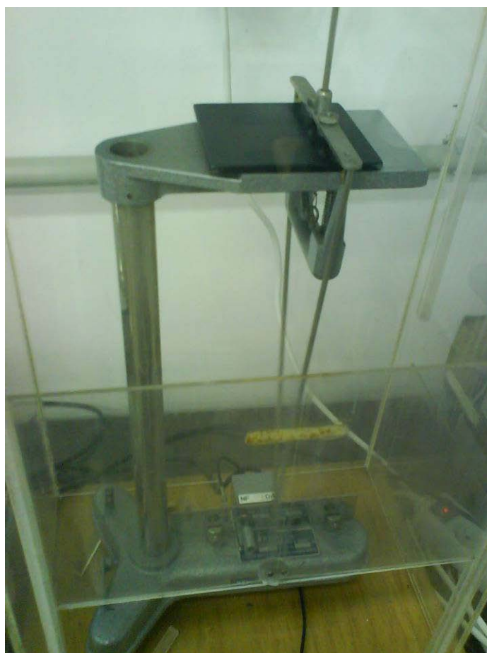
Slika 17: Naprava za merjenje trdote z dušenim nihanjem (Königovo nihalo).
