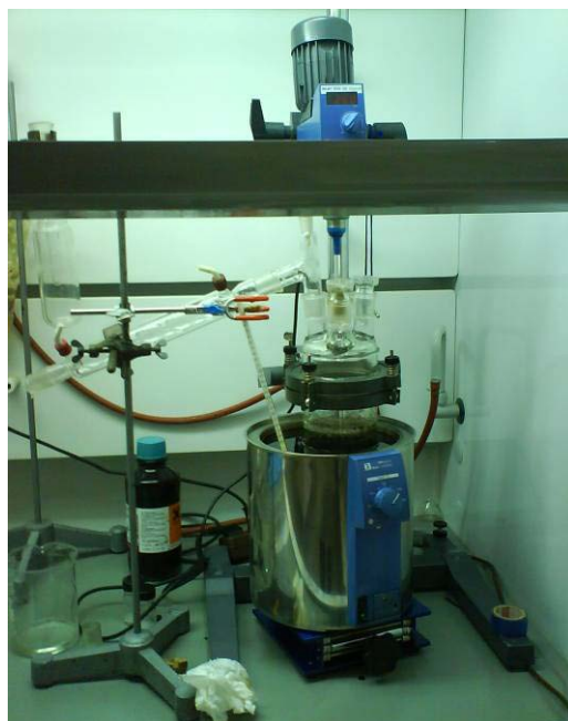
Slika 12: Pokrov s katerim smo pokrili čašo (levo) in celoten sistem v katerem poteka reakcija utekočinjenja (desno).
