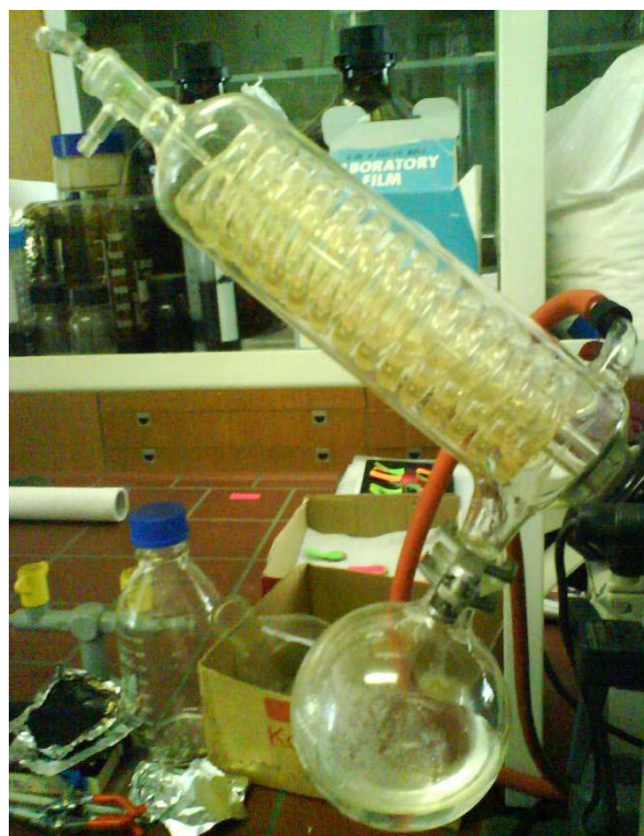
Slika 13: Hladilnik rotavaporja, na katerega neposredno povežemo visokozmogljivo membransko črpalko.
