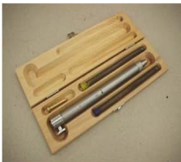
Slika 18: «Svinčnik», ki ga uporabljamo za merjenje trdote z metodo z razenjem (SIST EN 1518).
