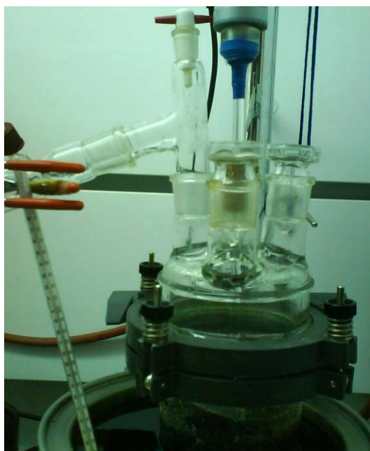
Slika 12: Pokrov s katerim smo pokrili čašo (levo) in celoten sistem v katerem poteka reakcija utekočinjenja (desno).
