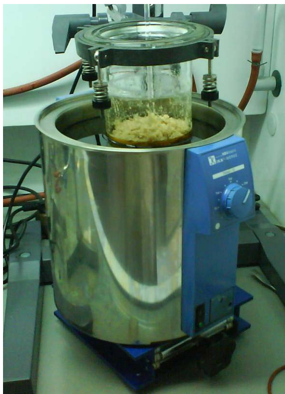
Slika 9: Reaktorska posoda nad oljno kopeljo (levo) ter električni mešalnik (desno).
