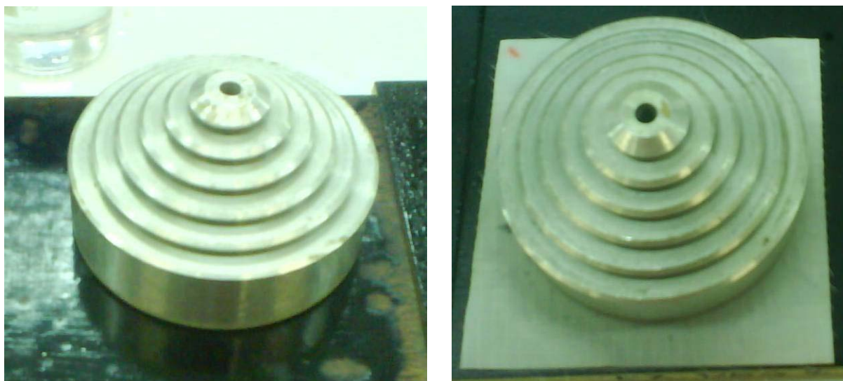
Slika 23: Aluminijast disk, ki smo ga segreli na 85 °C ter položili na vzorec za 20 min.
