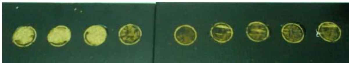
Slika 31: Lom kohezijske narave ter adhezijske narave pri površinskih sistemih EX DEG 1 in 3, pri dveh nanosih.
