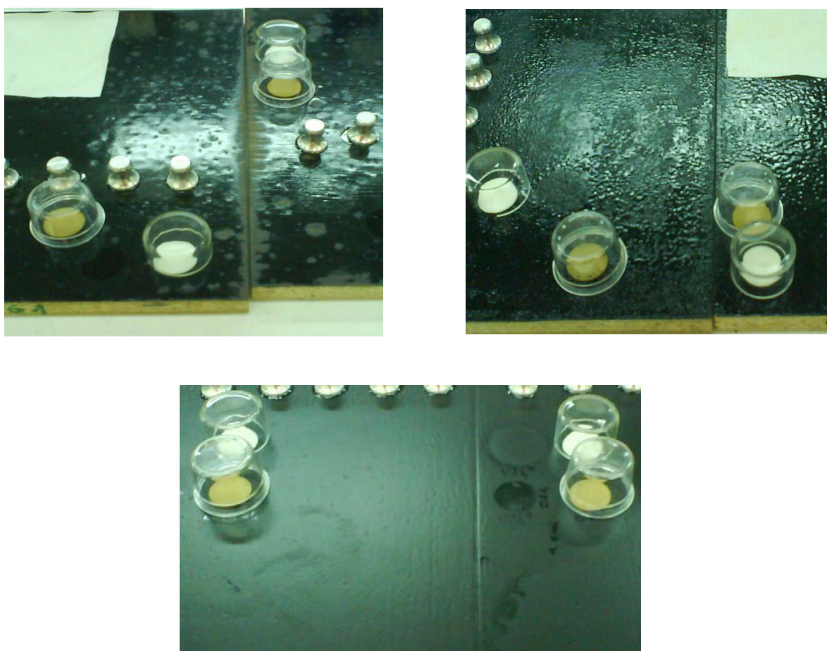
Slika 22: Določanje odpornosti proti tekočinam. Namočeni tamponi so pokriti s steklenimi čašami. (Površinski sistemi: DEG - zgoraj levo, GLIC - zgoraj desno, EX DEG - spodaj).
