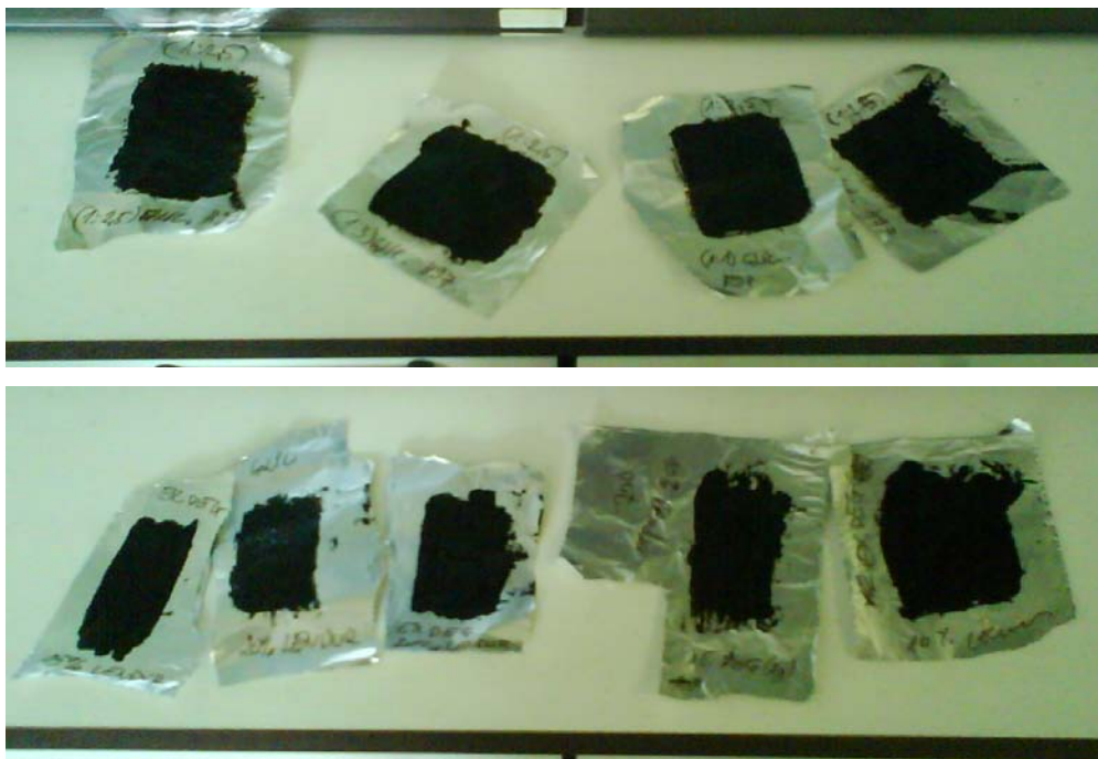
Slika 14: Premazi med utrjevanjem pri sobni temperaturi 20\text{ }^{\circ}\text{C} , različne formulacije.
