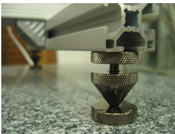
Slika 20: Stožčast vijak za nastavitev bazne višine
