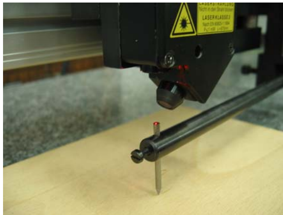
Slika 19: Merjenje spremembe višine z laserjem
