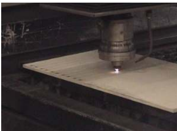
Slika 11: Izvedba laserskega reza na preskušancu debeline 16 mm
