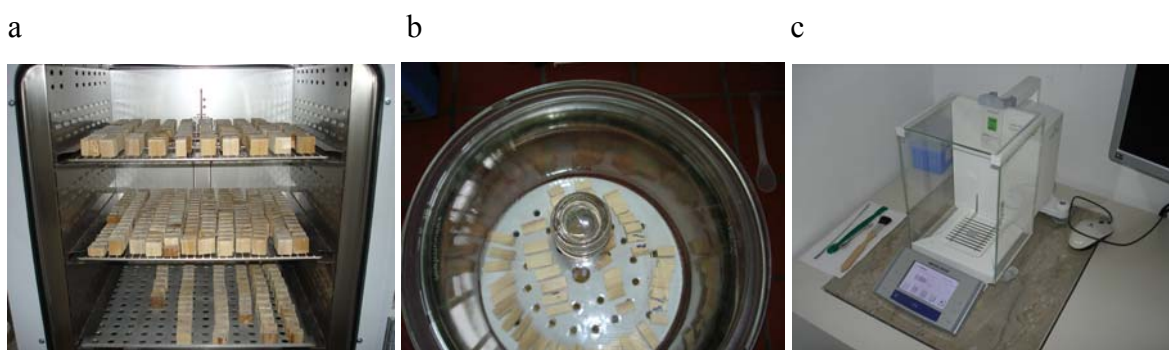
Slika 4: Priprava vzorcev in tehtanje: a) sušenje v sušilniku; b) ohlajanje vzorcev v eksikatorju; c) tehtnica (Mettler Toledo)
