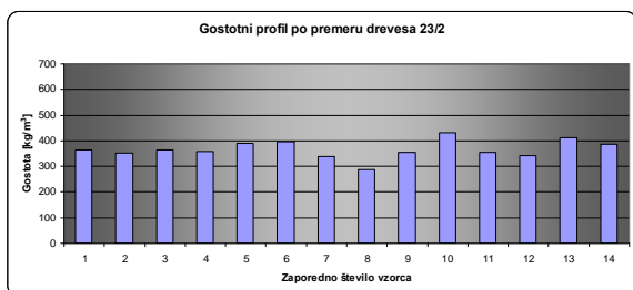
Slika 8: Grafični prikaz radialne porazdelitve gostote vzorcev kolotov dreves: 2/2, 3/2, 4/2, 7/2, 8/2, 11/2, 12/2, 13/2, 14/2, 17/2, 20/2, 22/2, 23/2 v prsni višini
