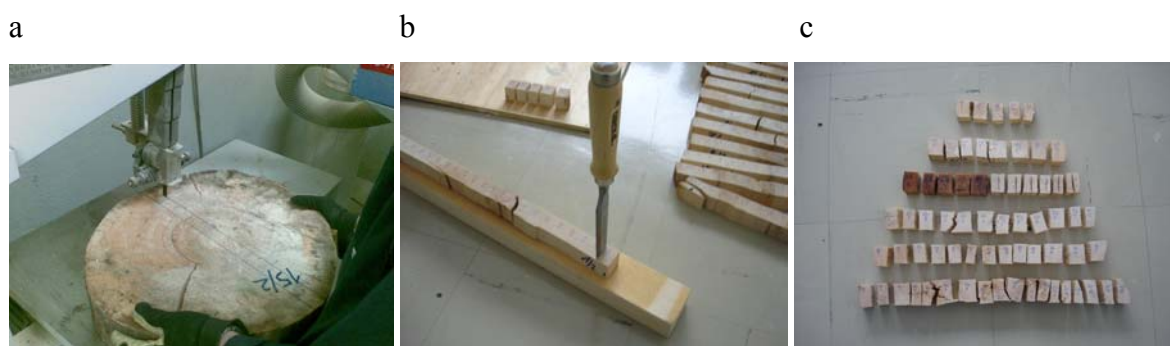
Slika 3: Priprava testnih vzorcev: a) izrez radialnih vzorcev iz koluta na tračnem žagalnem stroju; b) priprava testnih vzorcev, sekanje tangencialnega vzorca z dletom; c) testni vzorci debla drevesa številka šest
