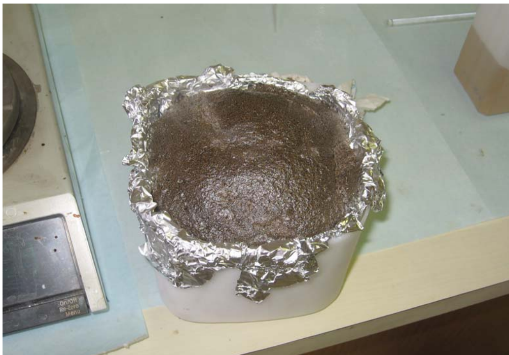
Slika 5: Prikaz poliuretanske pene po končani reakciji
