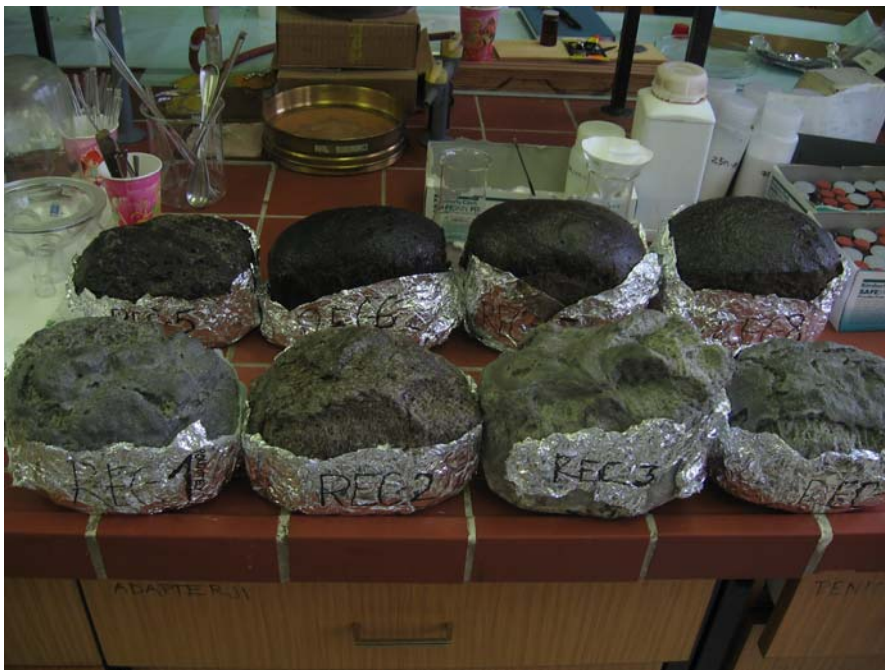
Slika 8: Poliuretanske pene izdelane iz linearnega poliestra
