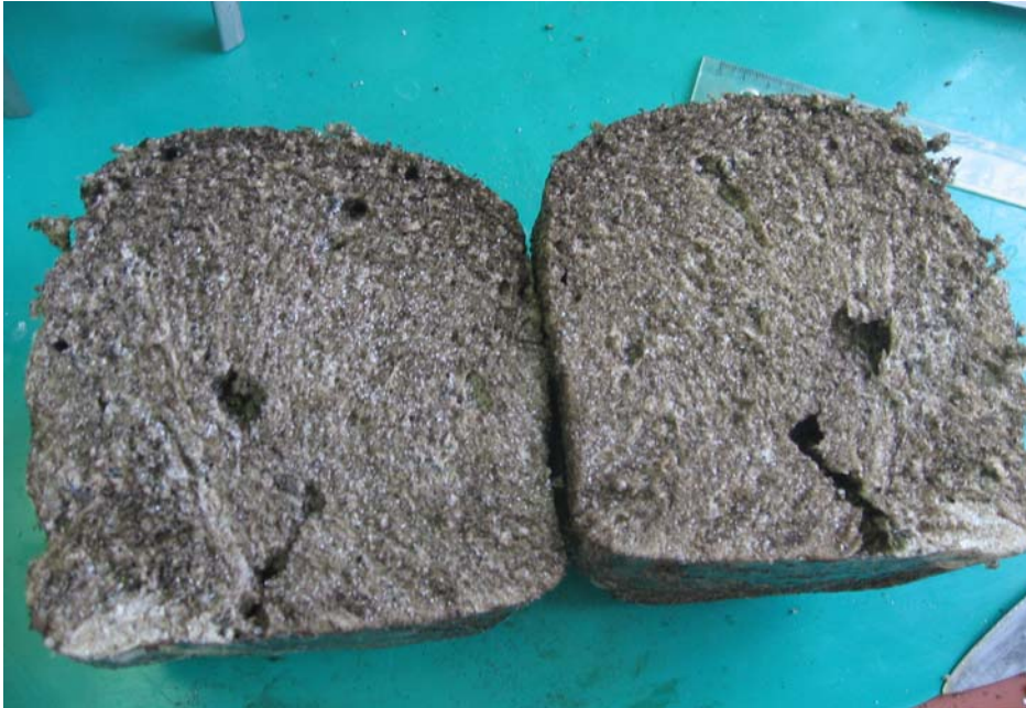
Slika 6: Priprava poliuretanske pene za izračun gostote
