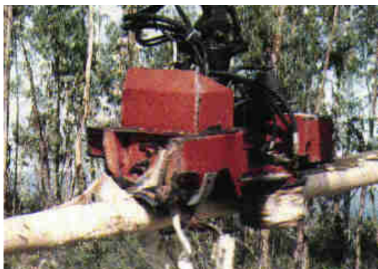
Slika 13 Specialna glava na gozdarskem harvesterju za žetev SRF (vir: biomatnet)
