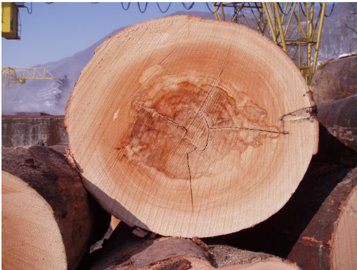
Slika 3: Celne razpoke, kolesivost kot posledica notranjih napetosti in rdece srce bukovine
