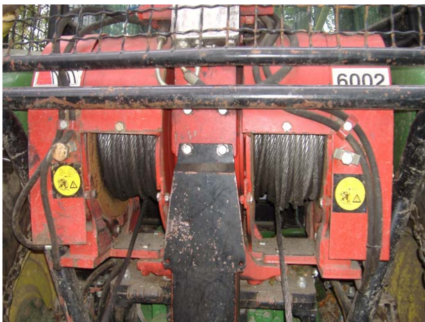
Slika 3: Dvobobenski vitel znamke Igland 6002 Pronto (Foto: Gorišek B.)
