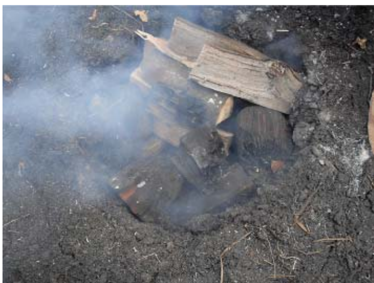
Slika 27: Polnitev stržena s kratkimi kosi lesa ali s kurabini (foto: B. Miklič)
