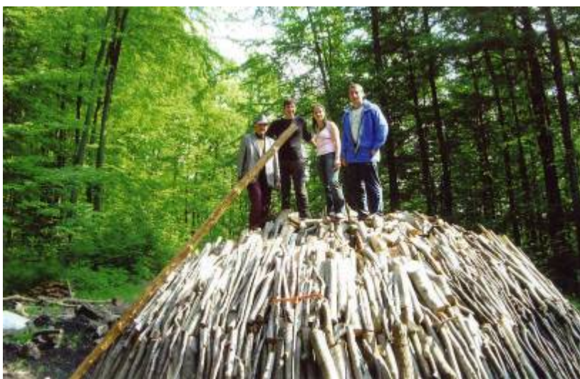
Slika 19: Zlaganje srednje velikih kop (foto: R. Grm)
