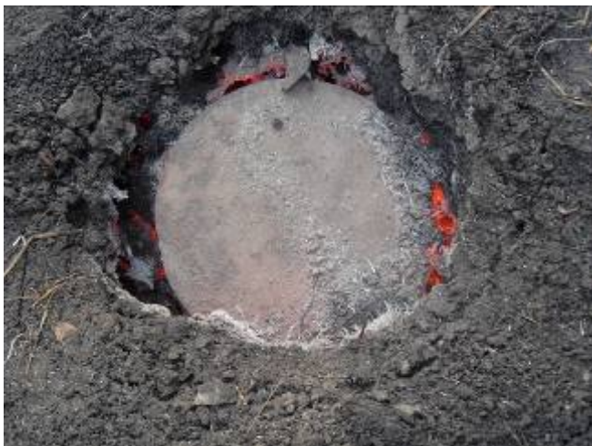
Slika 26: Stržen kope pokrit z železnim pokrovom (foto: B. Miklič)
