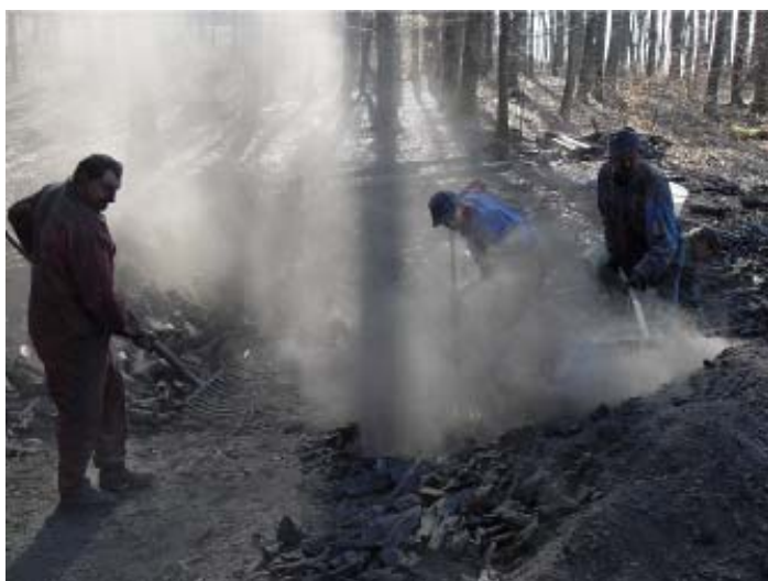
Slika 32: Razdiranje ali »štoranje« kope. (foto: B. Miklič)
