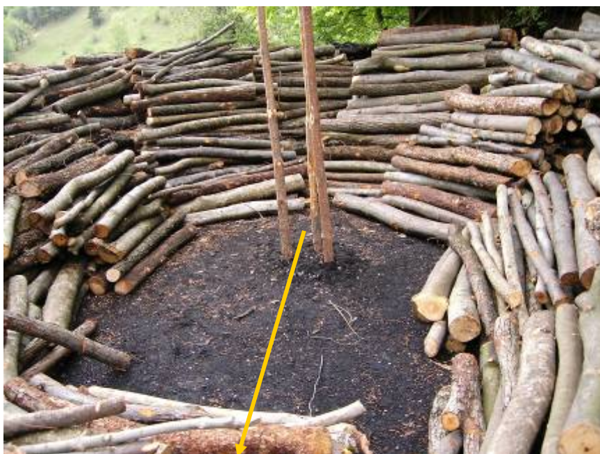
Slika 20: Na sredini stržen, okoli njega pa drva za zlaganje kope (foto: B. Miklič)
