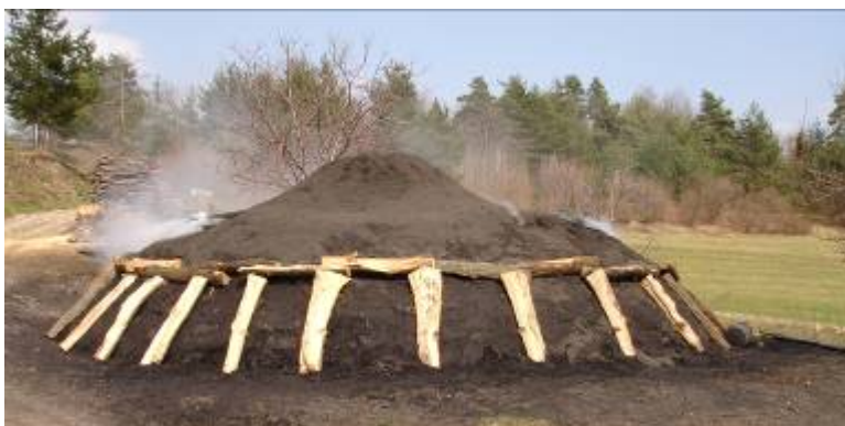
Slika 30: Neenakomerna oglenitev kope (foto: B. Miklič)
