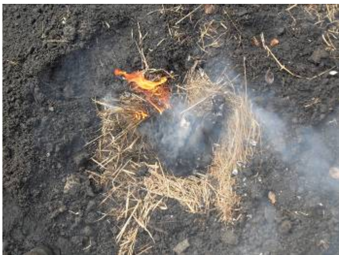
Slika 25: Drugi način zažiganja oglarske kope poteka z vrha proti dnu kope (foto: B. Miklič)
