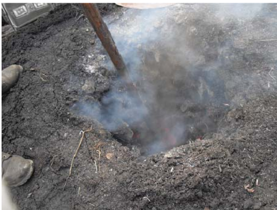
Slika 28: Z bokalnico oglar večkrat zrahlja gorivo v strženu (foto: B. Miklič)
