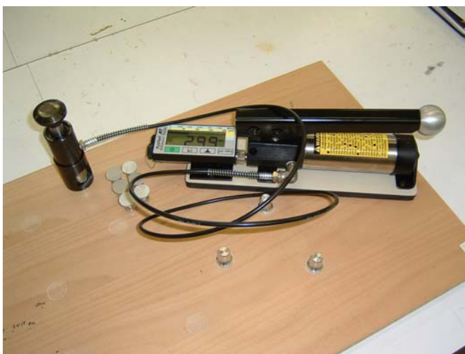
Slika 7: Naprava za merjenje oprijemnosti
