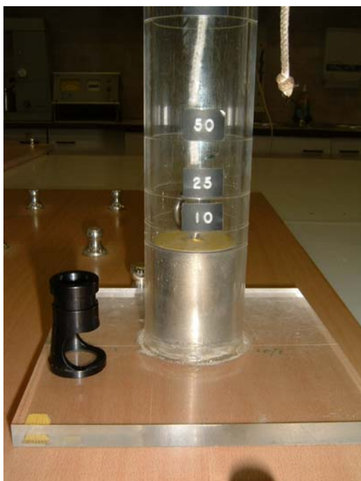
Slika 8: Naprava za merjenje odpornosti proti udarcem
