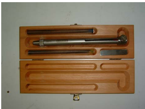
Slika 9: Naprava za merjenje razenja površine
