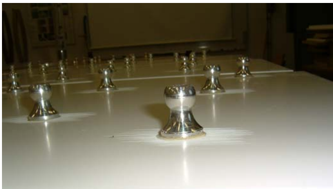
Slika 6: Priprava vzorca za merjenje oprijemnosti
