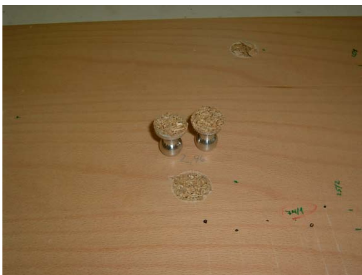
Slika 19: Površina po odtrganju pečata na bukovi podlagi
