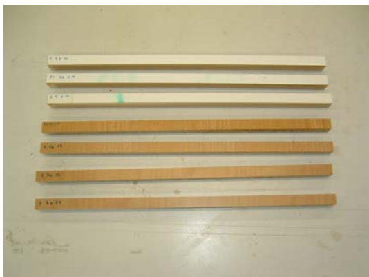
Slika 4: Priprava vzorcev za merjenje debeline filma
