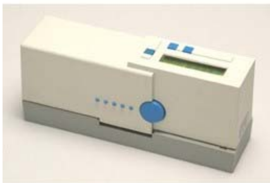
Slika 10: Naprava za merjenje sijaja
