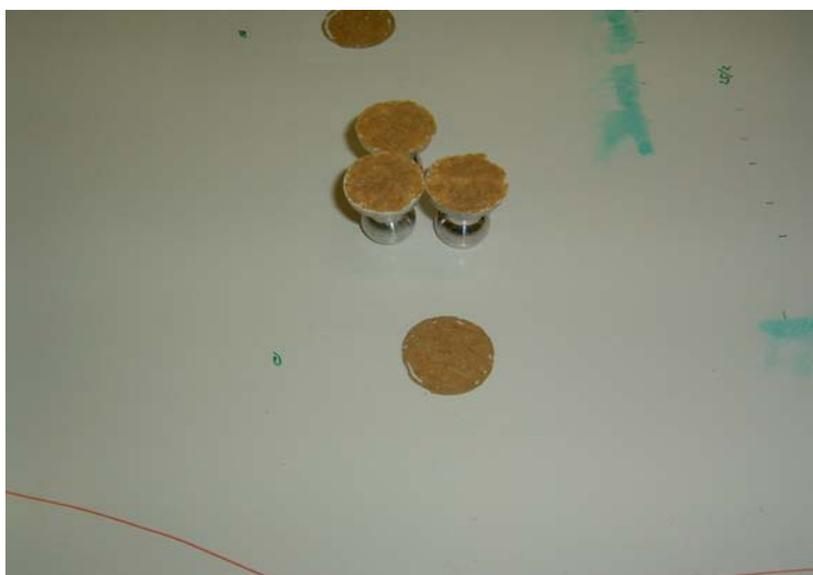
Slika 20: Prikaz površine po odtrganju pečata na MDF podlagi
