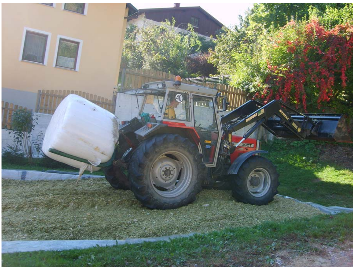
Slika 8: Tlačenje z dobro obteženim traktorjem
