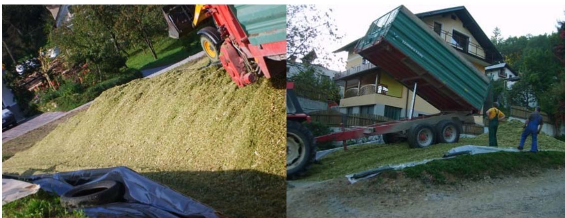
Slika 12: Razlika pri polnjenju silosa s prikolico s pomičnim dnom in kiper prikolico
