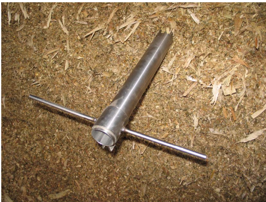
Slika 2: Sonda za vzorčenje silaž
