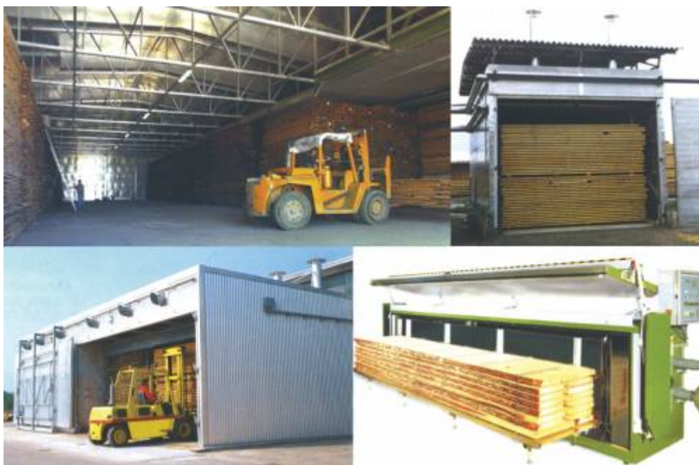
Slika 1 Različne zmogljivosti sušilnih komor: zgoraj levo – velikokapacitivna komora; zgoraj desno – »industrijska« komora; spodaj levo – dopolnilna komora in spodaj desno – obrtniška komora (Gorišek, 2004).
