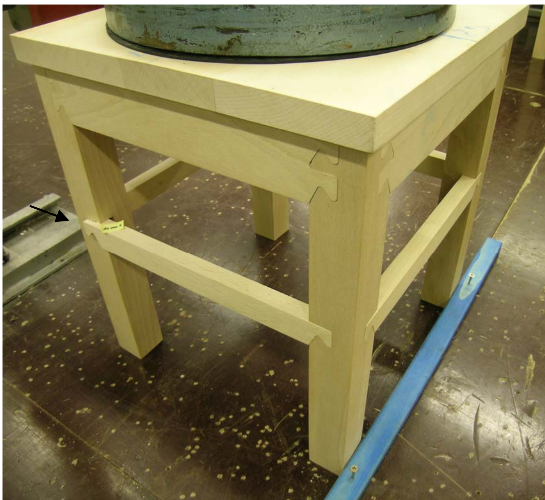
slika 63: Počasno izpadanje veznika med ciklusom ponovitev.
