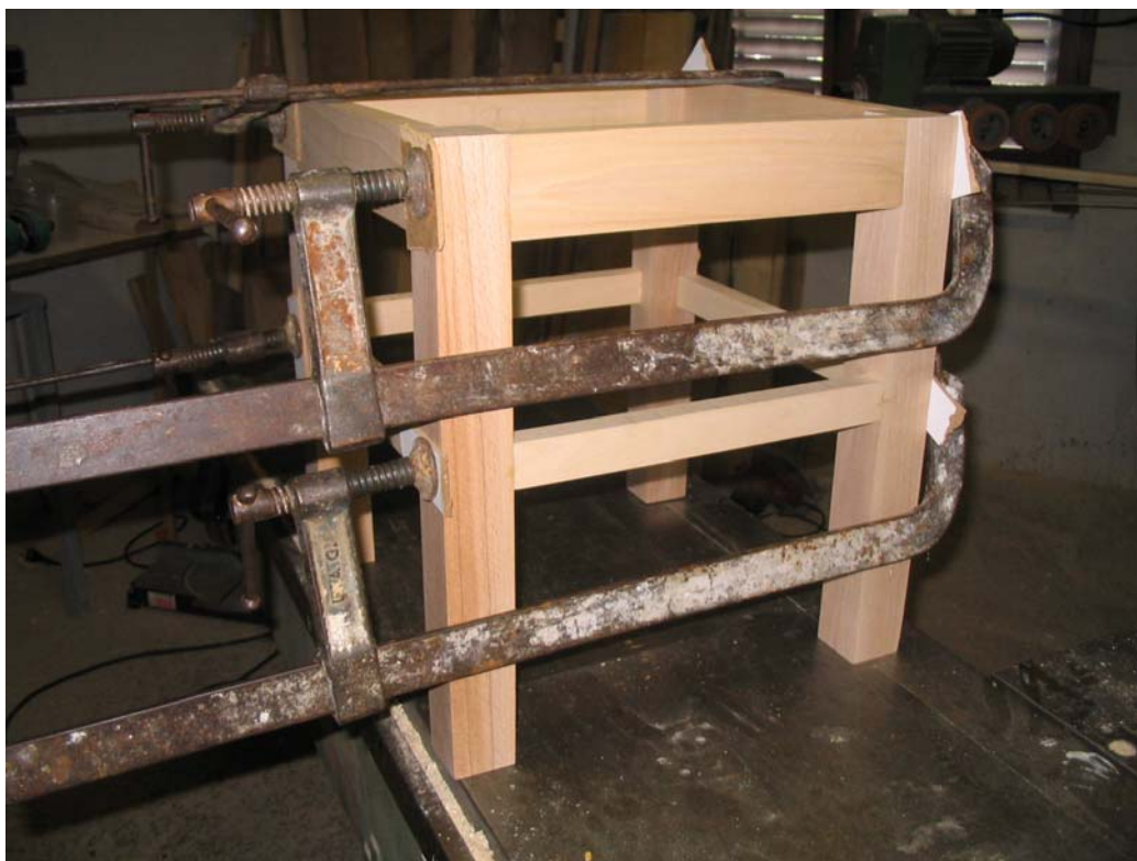
slika 58: Spajanje nog z mostniki in vezniki
