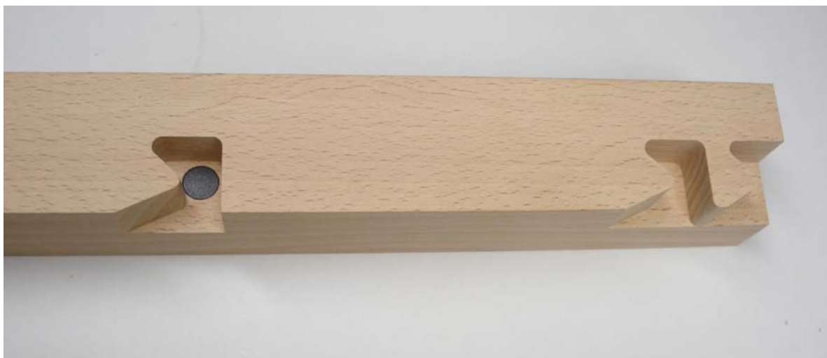
slika 52: Vstavljen magnet v utor za veznik
