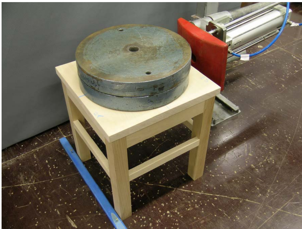
slika 59: Testiranje po standardu SIST EN 1728:02
