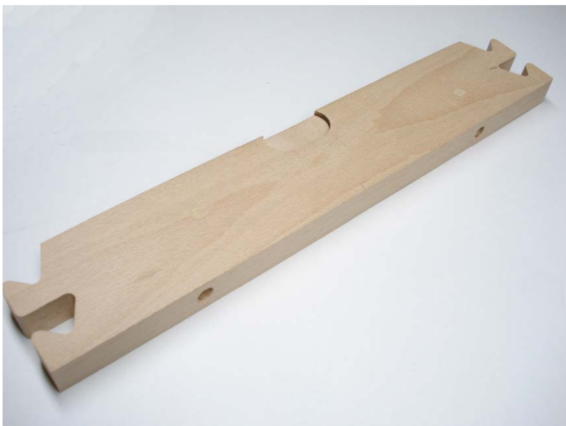
slika 50: Izreskan utor ter izvrtane luknje na mostniku
