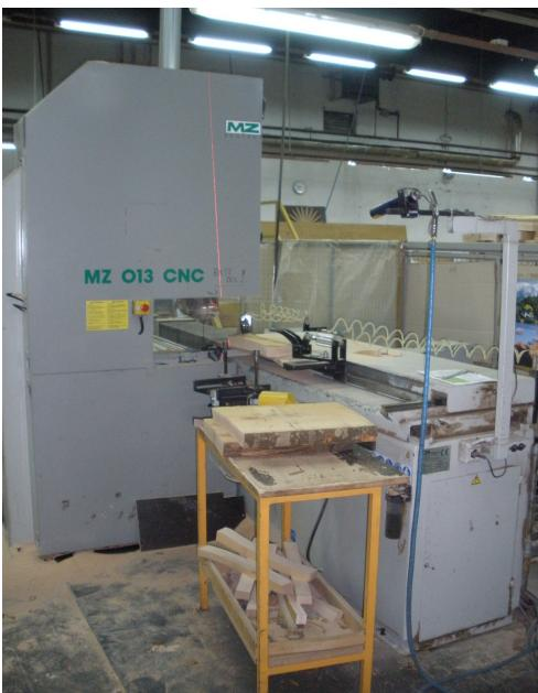
Slika 5: CNC (numerično krmiljen) tračni žagalni stroj za razrez risanih elementov.
