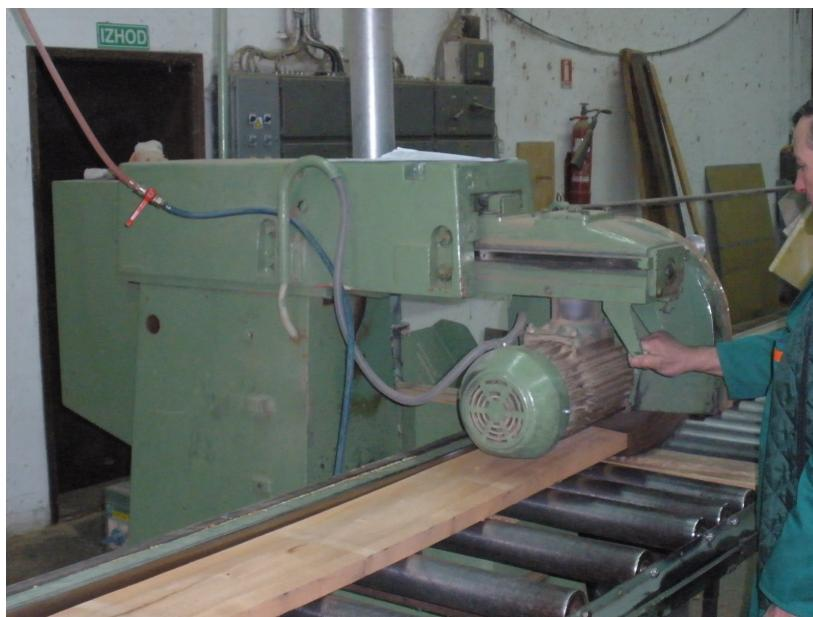
Slika 3: Žagalni stroj za prečni razrez lesa.
