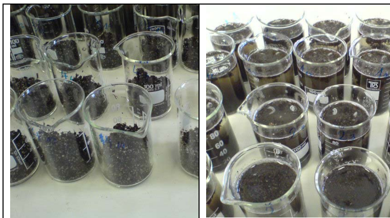
Slika 2: Priprava vzorcev zemlje za meritve pH vrednosti in slanosti substrata; Biotehniška fakulteta – laboratorij, 2007.
