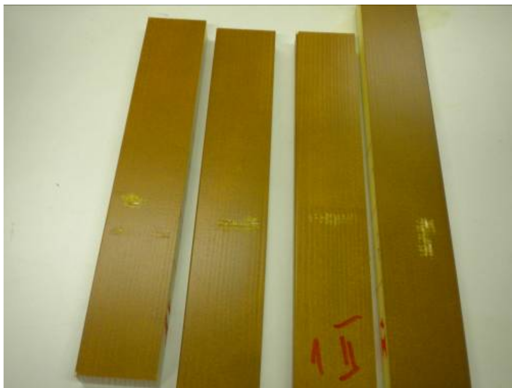
Slika 13: Rezultati določanja odpornosti proti zlepljanju po 24 urah, T = 23\text{ }^{\circ}\text{C} (smrekovina, premazana z lazuro)
