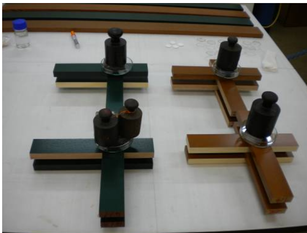
Slika 3: Priprava vzorcev na preizkus odpornosti proti zlepljanju
