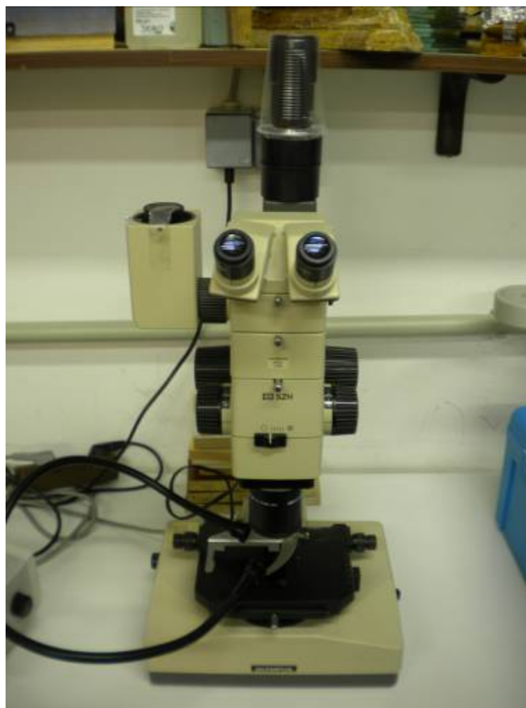
Slika 8: Stereo mikroskop za merjenje debeline filma
