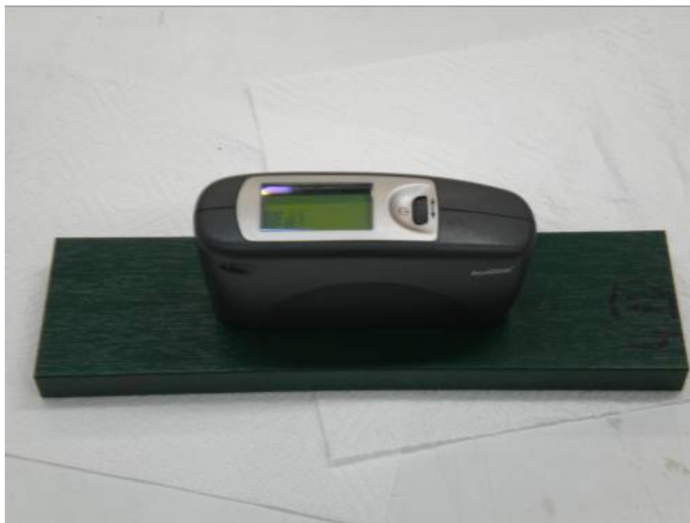
Slika 11: Instrument za merjenje sijaja
