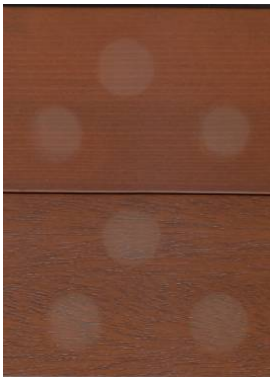
Slika 22: Svetli madeži na smrekovini (zgoraj) in lesu merantija (spodaj), premazanem z lazuro, po dveh dneh
