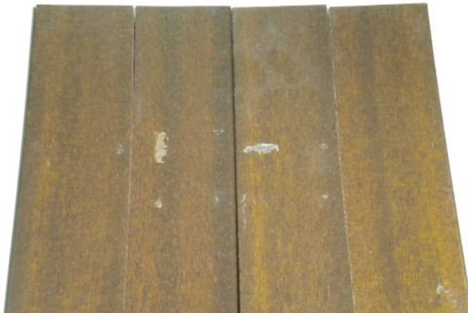
Slika 16: Rezultati testa za določanje odpornosti proti zlepljanju lesa merantija, premazanega z lazuro, po 24 urah pri T = 50\text{ °C}
