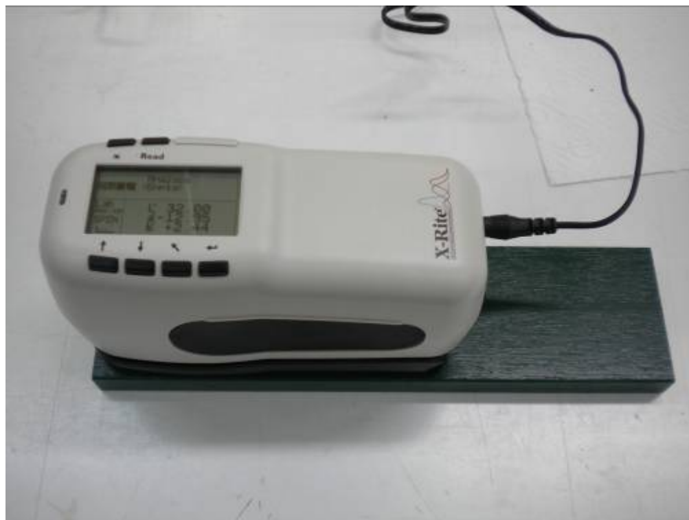
Slika 10: Naprava za merjenje barve-kolorimeter
