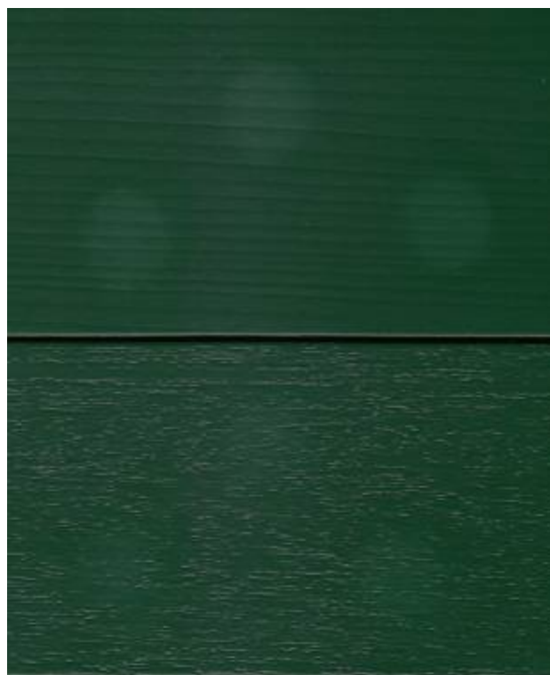
Slika 23: Svetli madeži na lesu smreke (zgoraj) in merantija (spodaj), premazanem s pokrivno barvo, po dveh dneh
