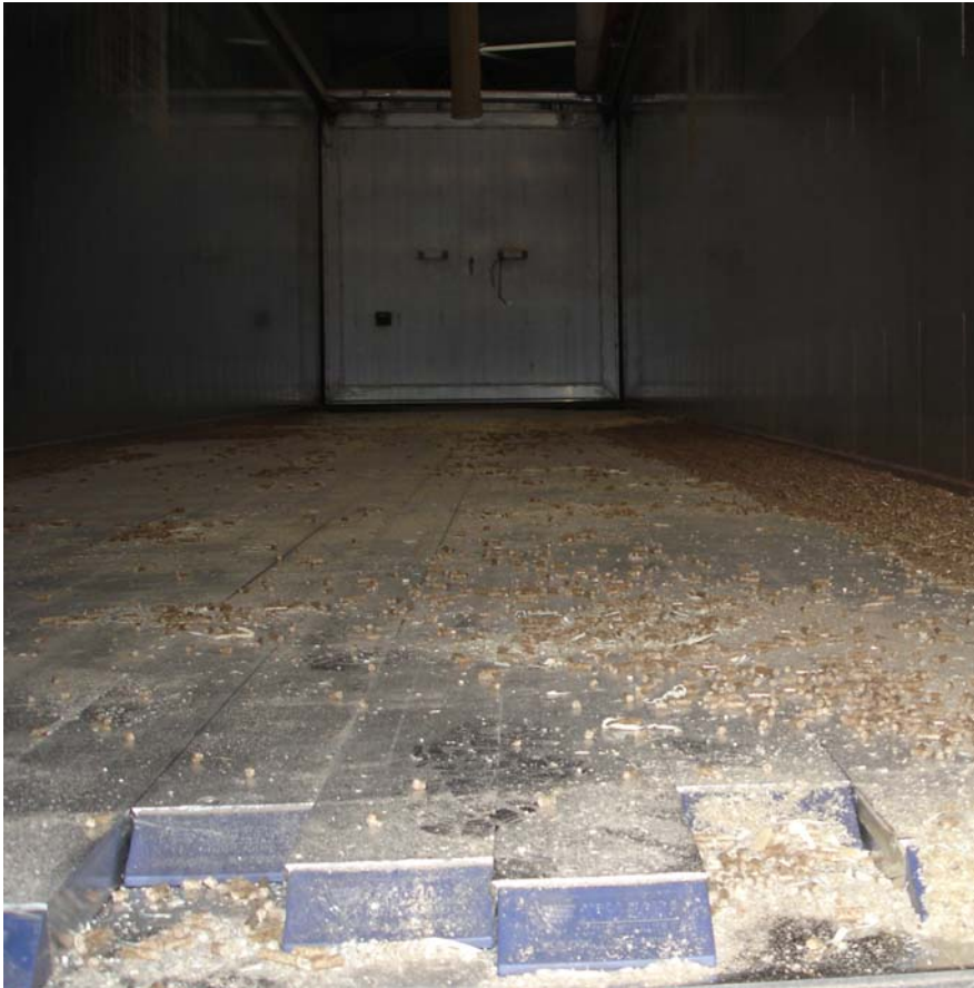
Slika 11: Premično dno polpriklopnika za prevoz peletov (foto B. Košir)
