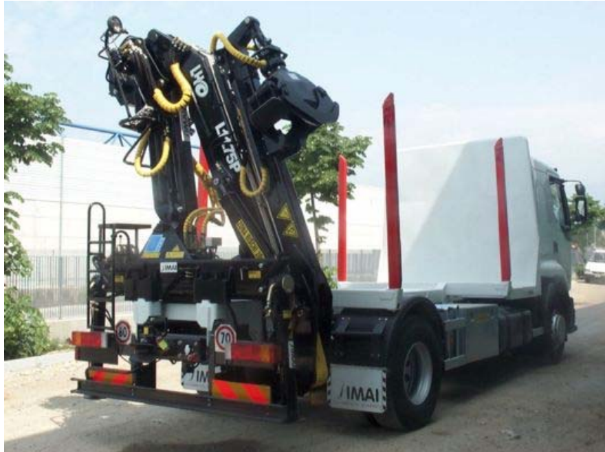
Slika 5: Dvigalo Liv ( tip Z ) vgrajeno zadaj za prevoz kratkega lesa (Liv, 2009)
