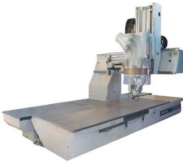
Slika 6: 5-osni CNC obdelovalni stroj Rutech robot 200 XM (SCM Group, 2008)
