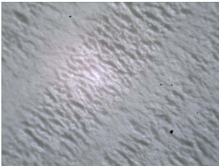
Slika 18: PTFE filter pod mikroskopom (70x povečava)
