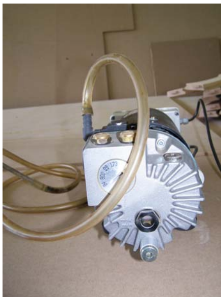
Slika 17: Vakuumska črpalka, ki zagotavlja ustrezen podtlak
