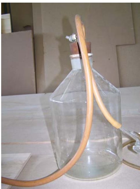
Slika 16: Balastna posoda za izničevanje nihanja
