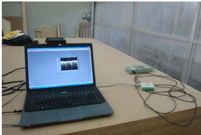
Slika 27: Merjenje hrupa in snemanje v programu labview
