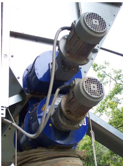
Slika 10: Vrhnji motor poganja polža v notranjosti sistema, spodnji pa celični dozator
