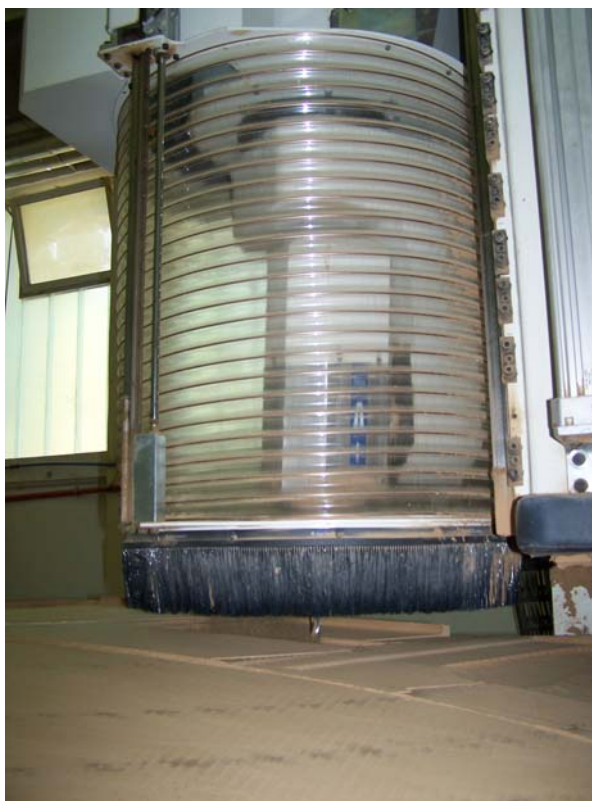
Slika 22: Razrez plošč in spuščena odsesovalna kapa na najnižjo pozicijo
