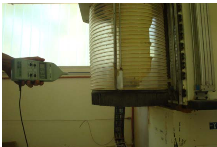
Slika 30: Spuščena odsesovalna kapa zakrije celo orodje
