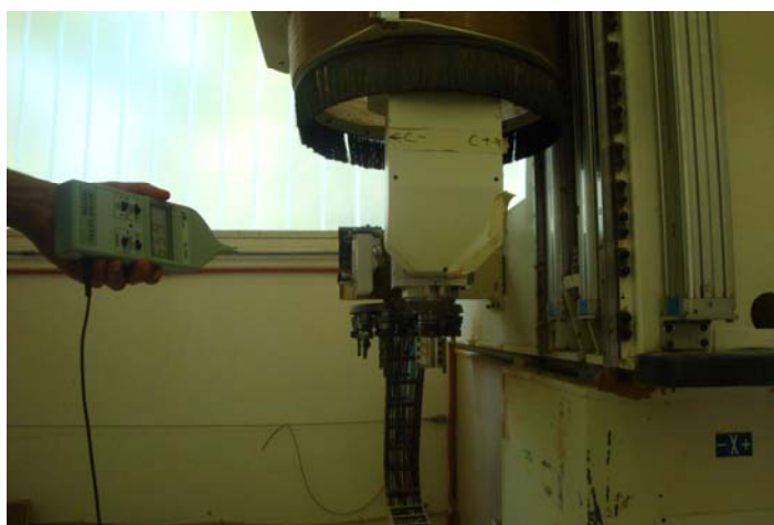
Slika 29: Večji premer orodja in dvignjena odsesovalna kapa
