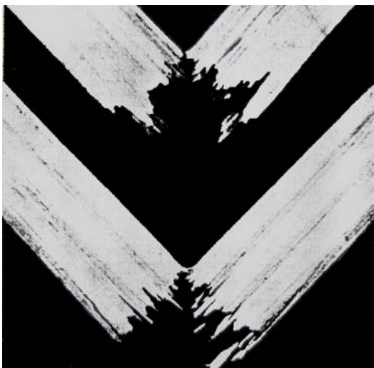
Slika 4: Prelom lesa s poprečnimi lastnostmi pokaže krajše, bolj vlaknate iveri (Kollmann 1984: 392)
