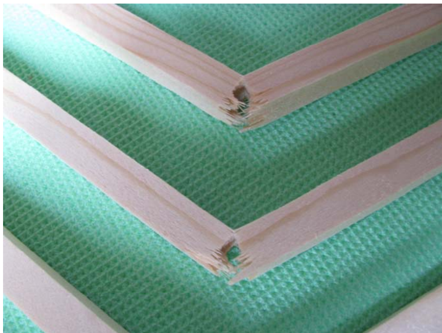
Slika 10: Običajen prelom preizkušancev pri preizkusu udarne žilavosti.
