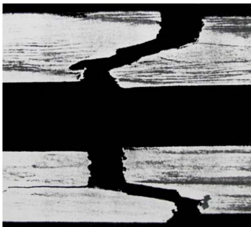
Slika 5: Ravne in gladke lomne površine nakazujejo na les z nizko udarno žilavostjo (Kollmann 1984: 392)
