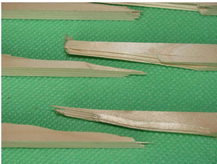
Slika 9: Dolg prelom preizkušancev pri testiranju udarne žilavosti.
