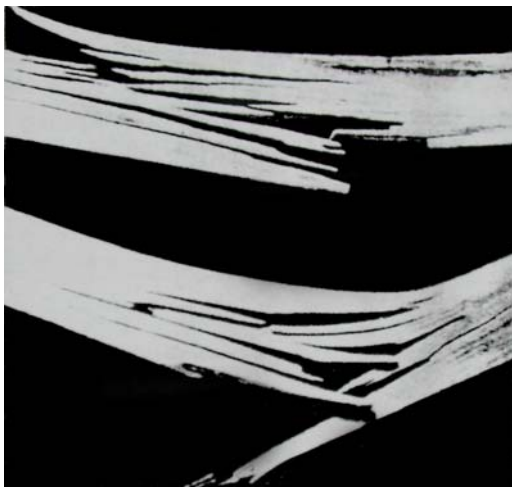
Slika 3: Primer lesa z visoko udarno žilavostjo (Kollmann 1984: 392)
