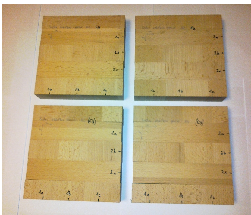
Slika 61: Preizkušanci C1, C2, C3 in C4 po testiranju – dolžinska odstopanja
