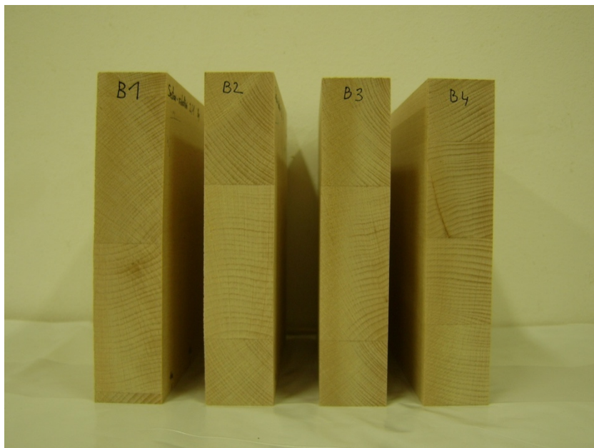
Slika 54: Preizkušanci B1, B2, B3 in B4 po testiranju – debelinska odstopanja
