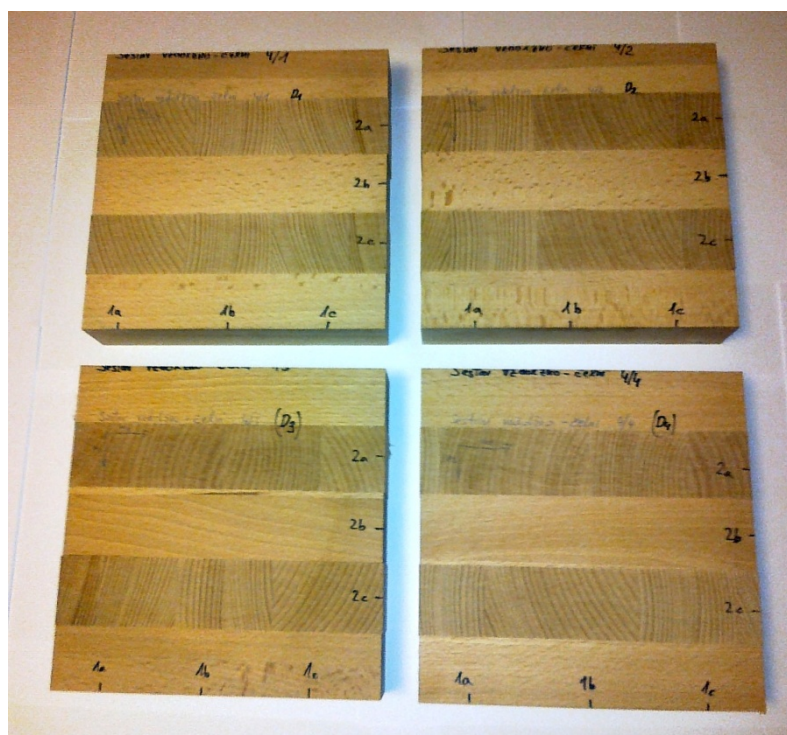
Slika 68: Preizkušanci C1, C2, C3 in C4 po testiranju – dolžinska odstopanja
