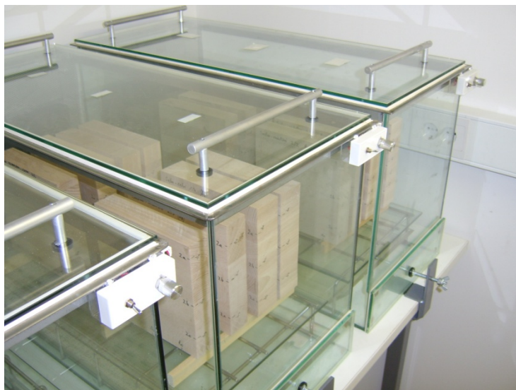
Slika 17: Steklena komora za ustvarjanje določenih klimatskih razmer
