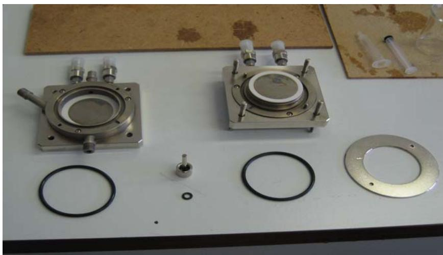
Slika 5: Prikaz razstavljene sonde na osnovne elemente: tesnila, distančnik in oba dela sonde z elektrodama.
