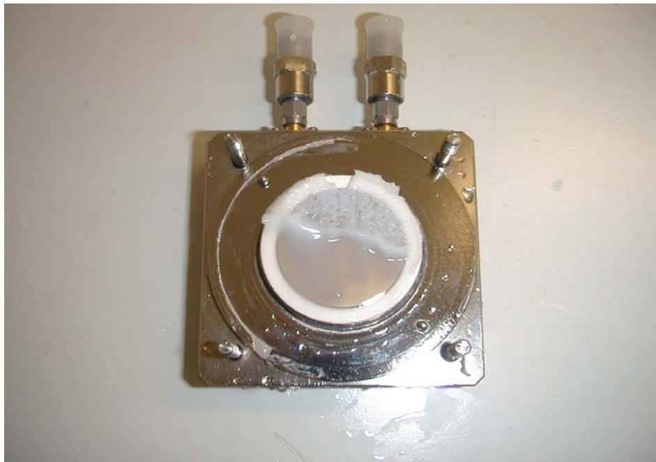
Priloga C: Prikaz lepila UF smola + katalizator, ki je utrdilo v sondi pri  $T = 70.91\text{ }^{\circ}\text{C}$ . Sondo smo odprli s pomočjo klešč, čiščenje je bilo zelo zamudno, saj se je lepilo prijelo na obe elektrodi.
