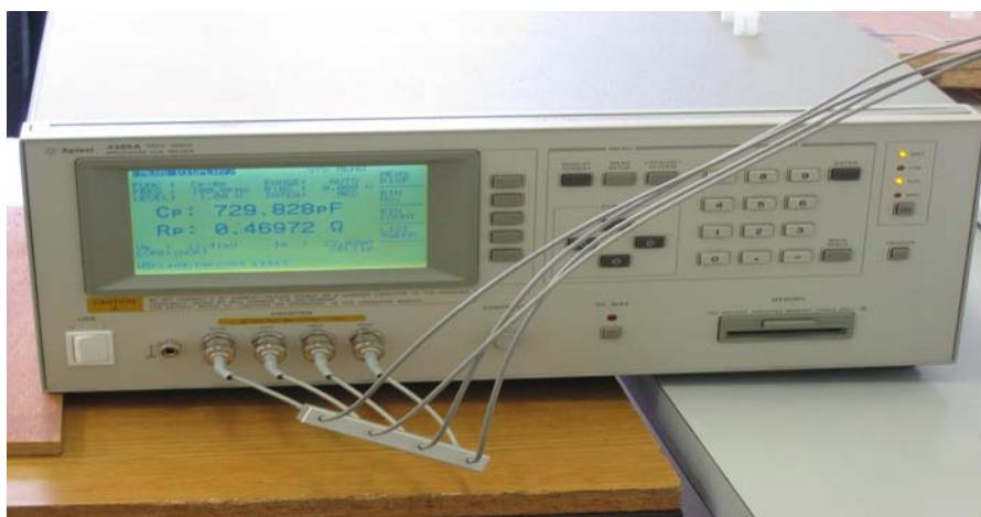
Slika 7: Natančni LCR meter Agilent 4285A za merjenje dielektričnih vrednosti količin na frekvenčnem območju od 75kHz do 30MHz.
