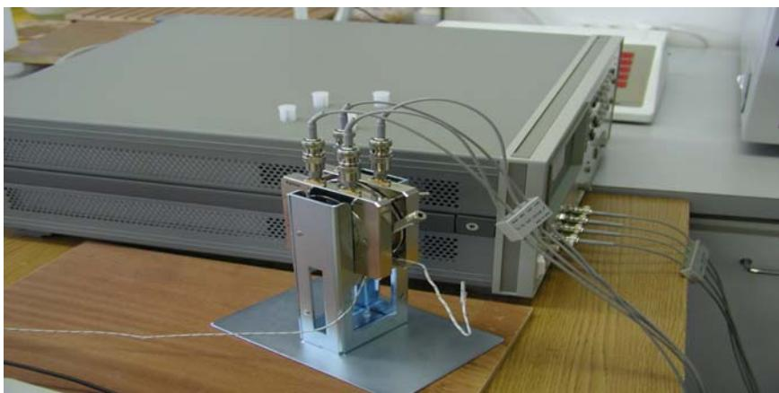
Slika 6: Priklopljeni sondi merjenje dielektričnih lastnosti tekočin na natančen LCR meter.
