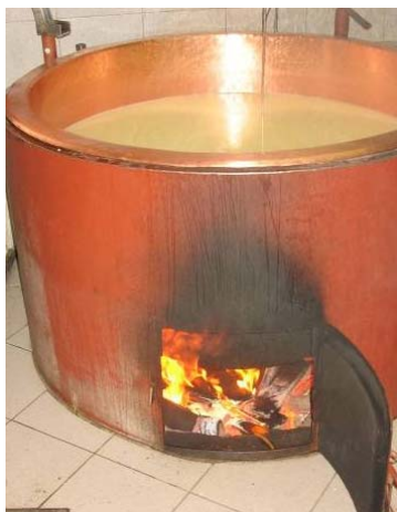
Slika 7: Segrevanje mleka v kotlu na drva, proizvajalec 1
