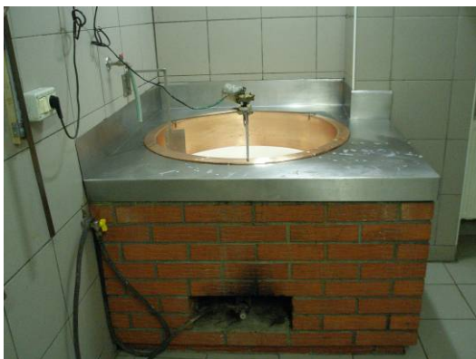
Slika 14: Segrevanje mleka v kotlu na plinski gorilnik, proizvajalec 2
