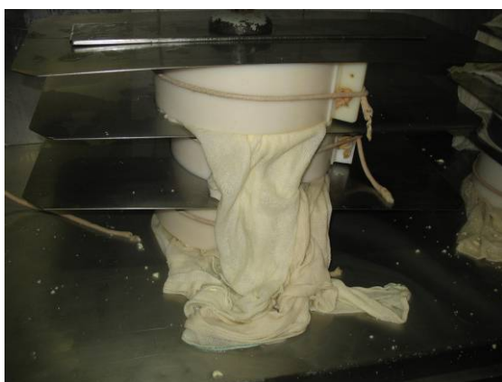
Slika 10: Stiskanje sira pod vzmetno prešo, proizvajalec 1
