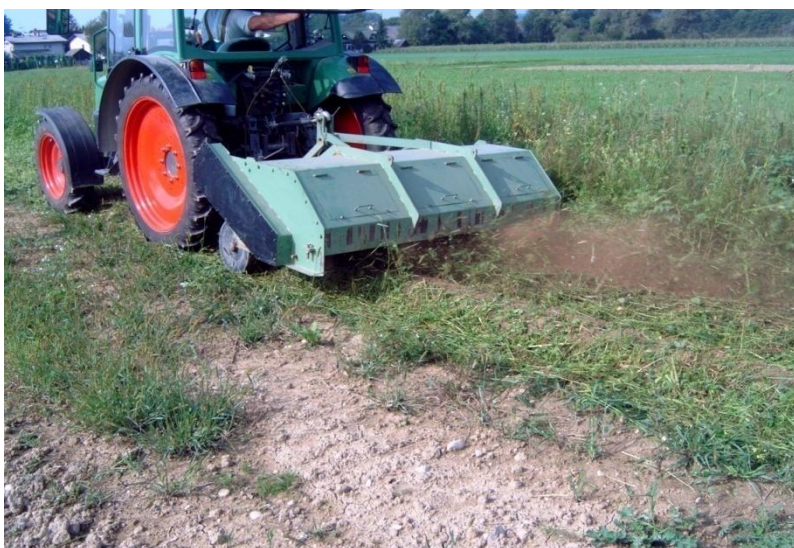
Slika 4: Uni evanje krompirjevke z dvovrstno zastiralno kosilnico med delom (foto: Ponikvar, 2006)
