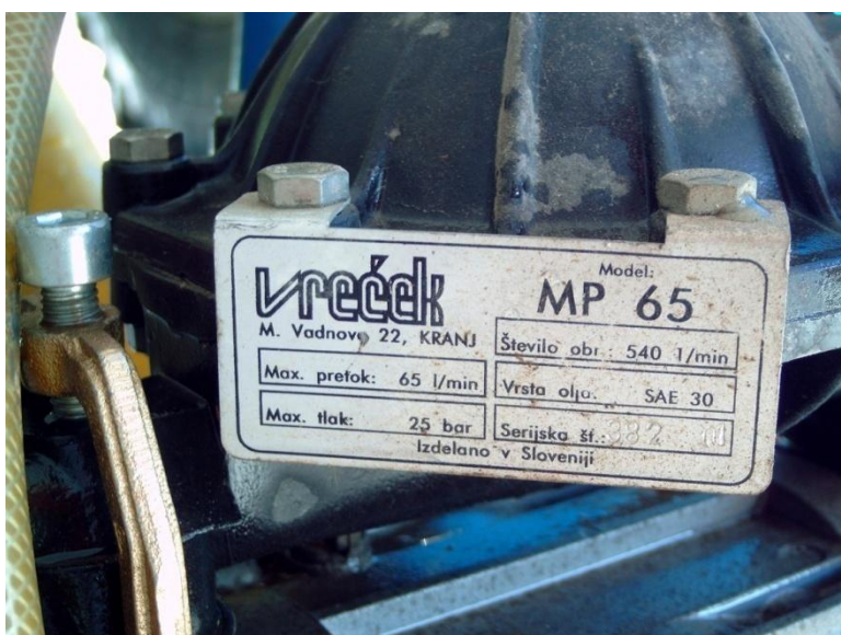
Slika 2: rpalka pri traktorski -kropilnici (foto: Ponikvar, 2006)
