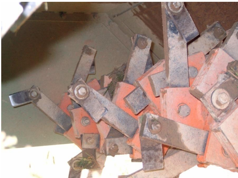
Slika 3: Rotor z noffi pri zastiralni kosilnici (foto: Ponikvar, 2006)
