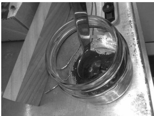
Slika 4: Mešanje epoksi smole in grafita
