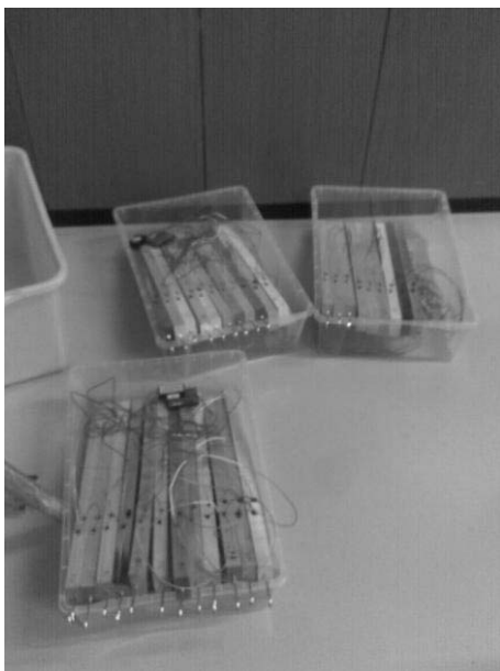
Slika 6: Vzorci z vstavljeno jekleno žico povezani z baterijami in čitalcem podatkov
