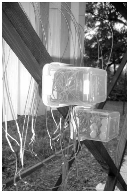
Slika 7: Zavarovanje baterij in čitalcev podatkov pred vlago
