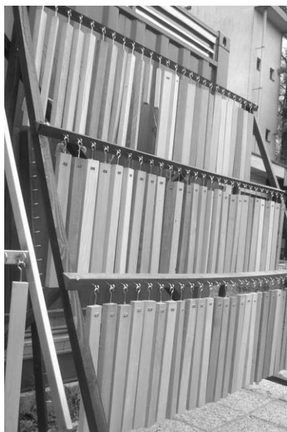
Slika 8: Viseči vzorci na terenski izpostavi Odd. za lesarstvo na BF
