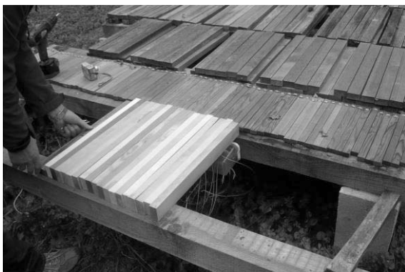
Slika 9: Nameščanje ležeče izpostavljenih vzorcev (enoslojni test)
