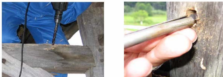
Slika 8: Vrtanje izvrtka-levo, izvlek izvrtka za dendrokronološko analizo-desno (iz Zaletelj, 2006)
