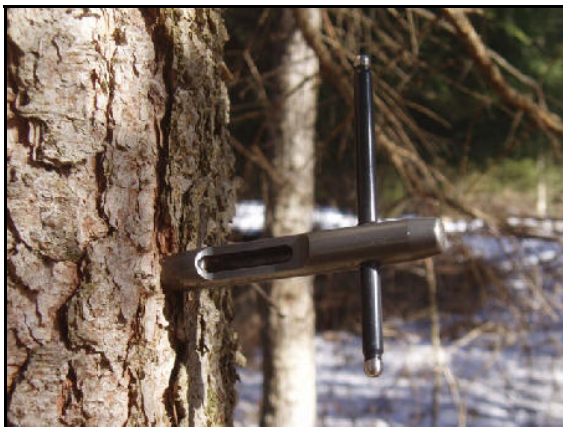
Slika 4: A-Trephor zabiti v deblu, B-vzorec viden v trephorju http://www.tesaf.unipd.it/Sanvito/trephorEN.asp
