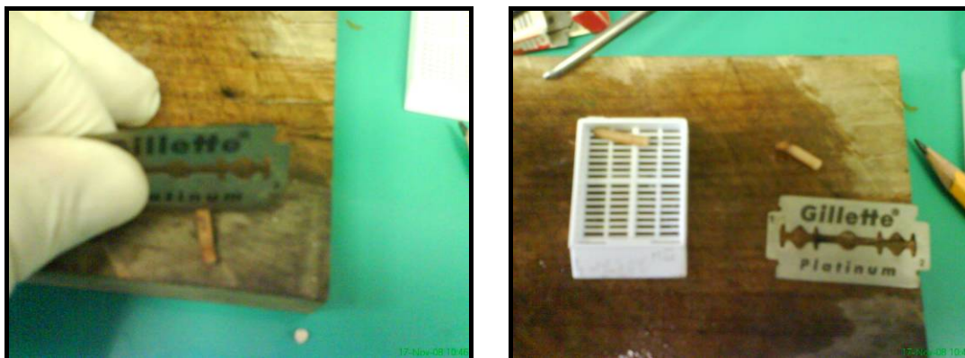
Slika 5: A - obrezovanje mikroizvrtka z britvico, B - kaseta z mikroizvrtkom in obrezan mikroizvrtek
