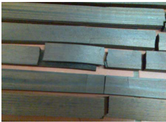
Slika 22: Poškodbe modificiranih vzorcev pri temperaturi 230 °C
