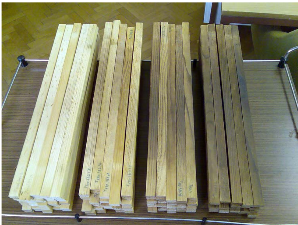
Slika 16: Primerjava barvnih odtenkov z višanjem stopnje termične modifikacije lesa. Levi vzorci so bili modificirani pri 150 °C, desni pa pri 210 °C.
