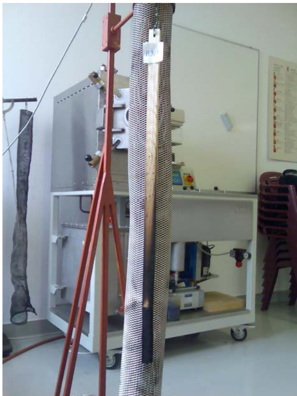
Slika 20: Prikaz poškodovanosti pri vzorcu zaščiten z 10 % vodno raztopino Topbora (B3/1)
