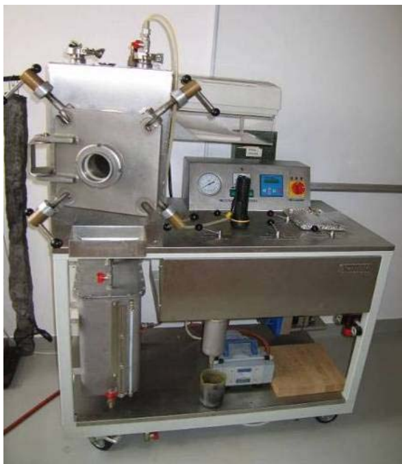
Slika 14: Vakuumsko-tlačna komora KAMBIČ
