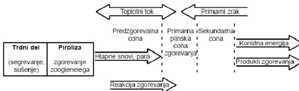
Slika 6: Splošni model zgorevanja lesne biomase (Butala in Turk, 1998)
