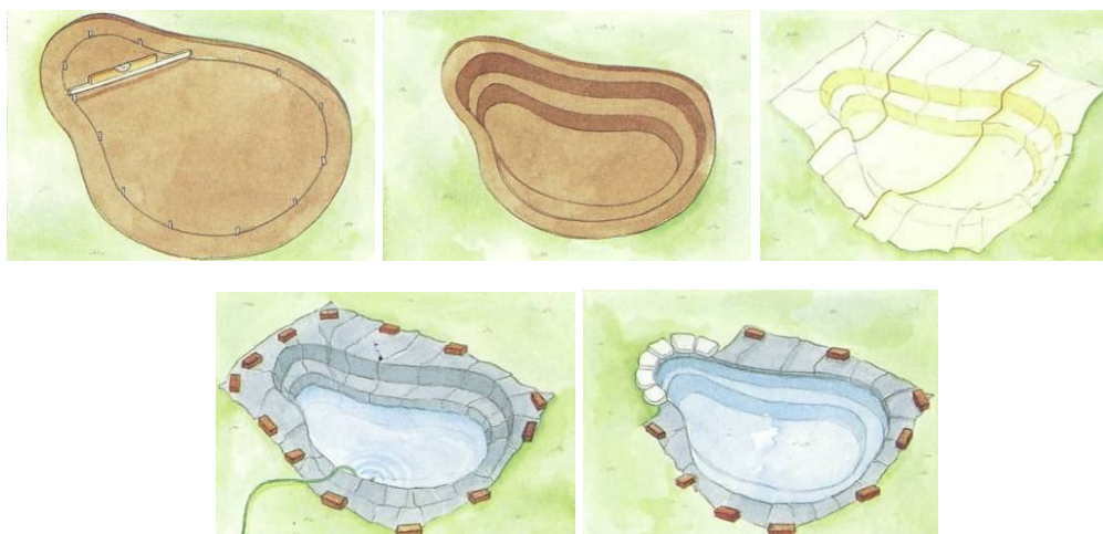
Slika 1: Potek izdelave ribnika s folijo (Allison, 1993)
