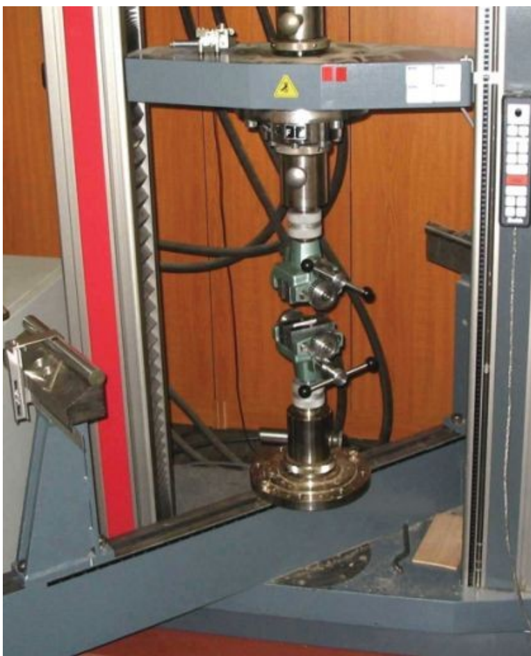
Slika 6: Čeljusti za vpetje strižnega preskušanca v univerzalni testirni stroj Zwick Z100.
