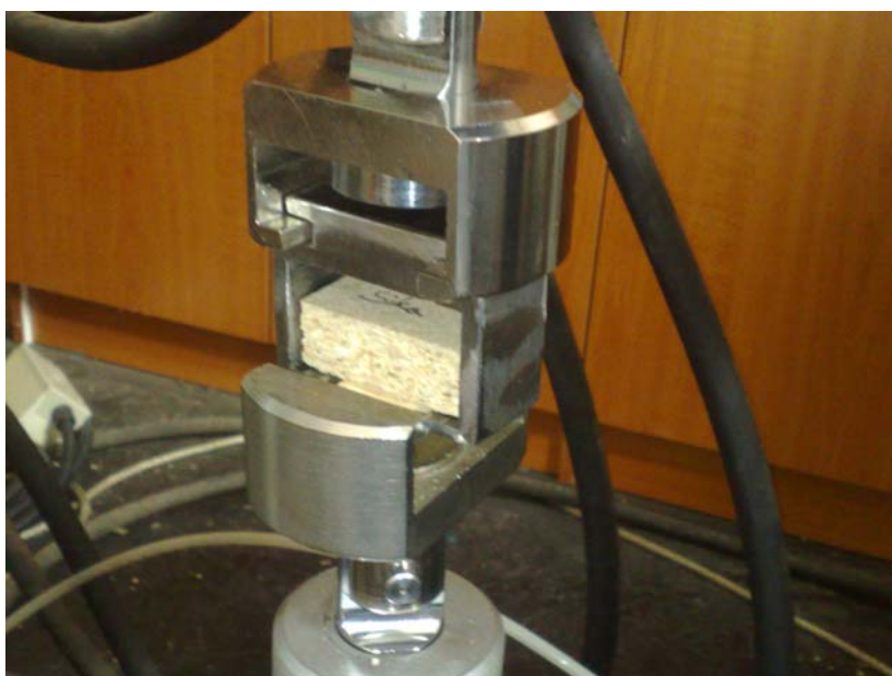
Slika 12: Preskušavec, vpet v vpenjalni čeljusti na Zwicku Z100 za ugotavljanje natezne trdnosti.
