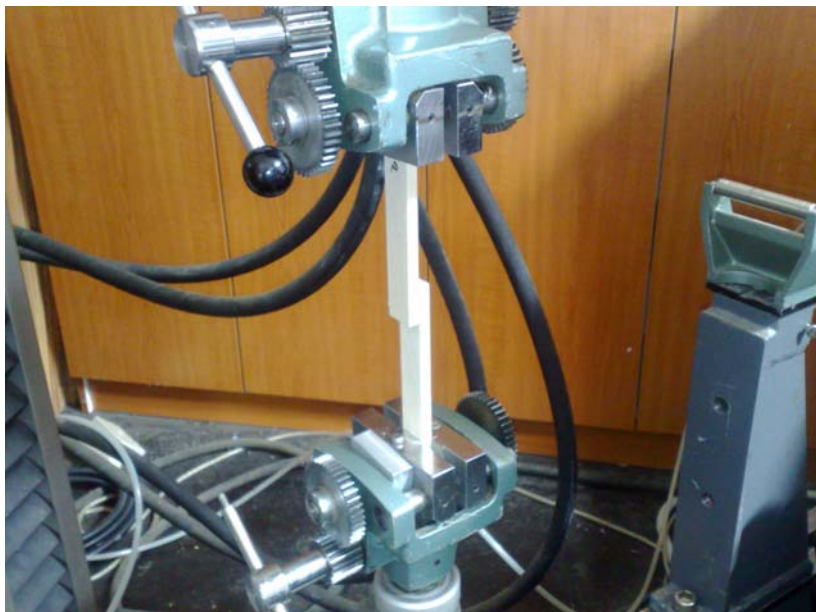
Slika 11: Preskušavec, vpet v vpenjalni čeljusti univerzalnega testirnega stroja Zwick Z100 za ugotavljanje strižne trdnosti.
