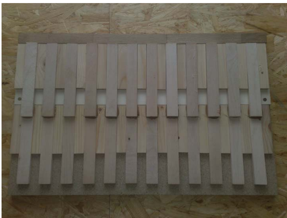
Slika 8: Šablona in lepljenje preskušancev za ugotavljanje strižne trdnosti lepilnega spoja.
