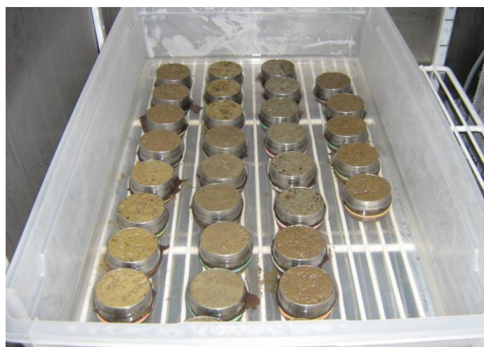
Slika 7: Navlaževanje neporušenih vzorcev tal v Kopeckyevih cilindrih (NTC-sv)
