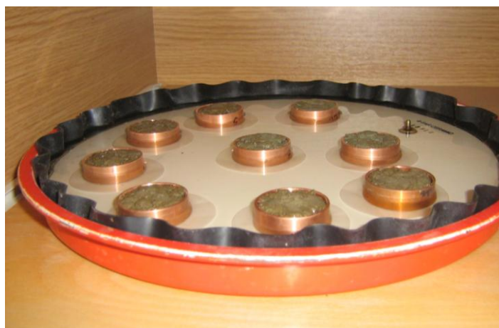
Slika 8: Navlaževanje svežih vzorcev tal polnjenih v cilindre z upoštevanjem dejanske volumske gostote PTC-sv
