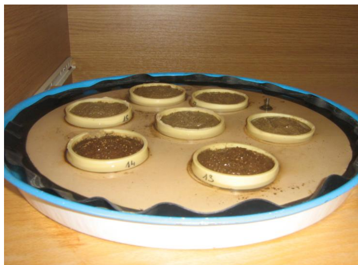
Slika 9: Navlaževanje suhih porušenih vzorcev nasutih v obroče ( PT-s ).
