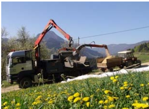
Slika 16: Mletje svežega lesa z velikim sekalnikom (foto: N. Krajnc)
